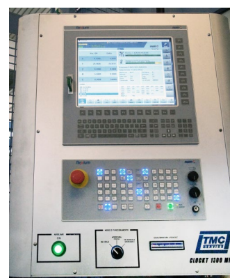
Pannello di controllo con CNC Flexium + 68 di NUM installato sul centro di lavoro Tank 1300 MCM
