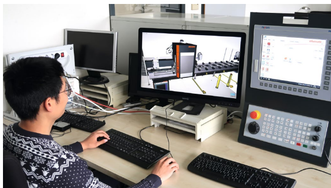
一名员工在 elumatec AG 的虚拟调试系统上仿真 SBZ 151 的功能
