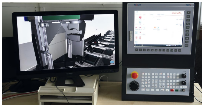
在 elumatec 的虚拟调试系统中，所有的控制部件都是一对一的虚拟复制。屏幕显示 SBZ 151 加工头
