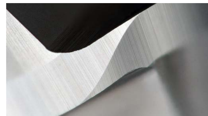
Figura 2: Tagliente trasversale misurato con il microscopio digitale Keyence (ingrandimento 200:1)
