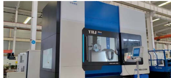
YHJMKG2880, una rettificatrice verticale universale CNC ad alta precisione
