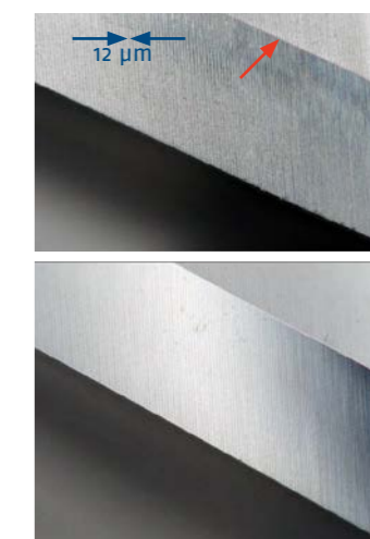
Figura 3: Fotomicrografia con ingrandimento 200X che contrasta l'effetto sulla qualità della superficie dell'utensile di (in alto) una mola non correttamente rinvivata e (in basso) di una mola correttamente rinvivata
