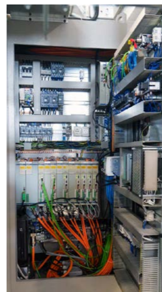
Techno Multiwall monta un controllo numerico Flexium+ 68 fornito da NUM con motori e azionamenti
