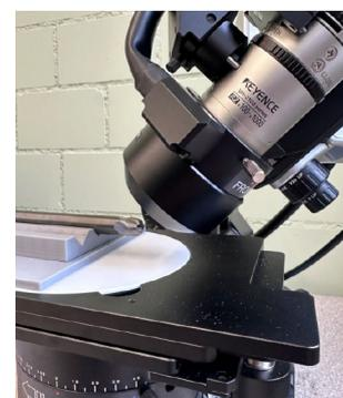
Mesure de l'arête de coupe sur la fraise à rayon complet sous 45°
