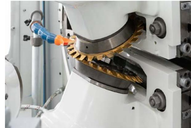
Im Mittelpunkt des Projekts stand die Konstruktion der beiden Fräsköpfe (die ursprünglich von einem einzigen Motor angetrieben wurden), indem zwei Motoren in sie eingefügt wurden, um eine höhere Geschwindigkeit zu erreichen
