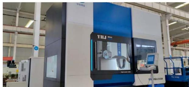
YHJMKG2880, eine hochpräzise CNC-Universal-Vertikalschleifmaschine
