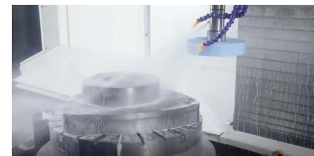
Schleifen von speziell gekrümmten Oberflächen
