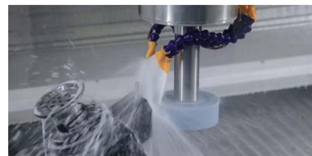
Automatisches Abrichten der Schleifscheibe
