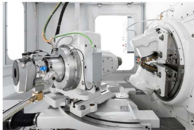
Die Zusammenarbeit zwischen NUM und Lanzi besteht schon seit langem und wurde im Laufe der Zeit durch verschiedene Projekte vertieft. Das jüngste Projekt ist der Retrofit einer alten Kegelrad-Wälzfräsmaschine für geradverzahnte Zähne
