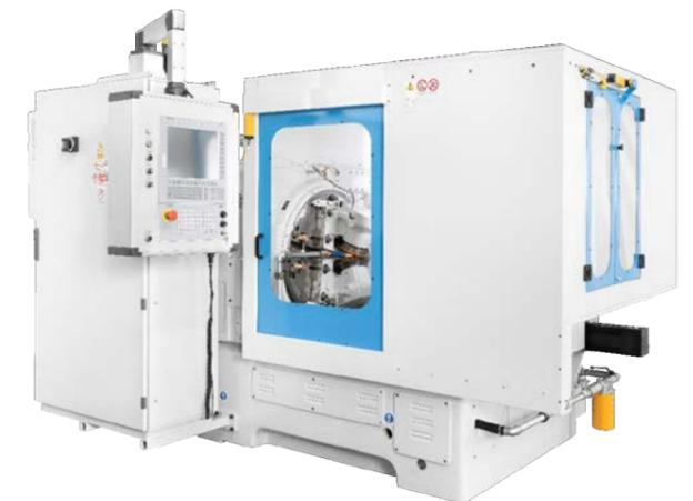
Mit der Umrüstung dieser Wälzfräsmaschine verfolgt Lanzi konsequent das Ziel, den Einsatz von Hartmetallfräsern zu ermöglichen
