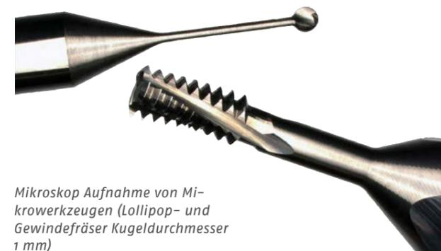
Mikroskop Aufnahme von Mikrowerkzeugen (Lollipop- und Gewindefräser Kugeldurchmesser 1 mm)
