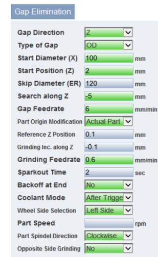
Abbildung 5: Gap Elimination Dateneingabemaske im NUMgrind HMI
