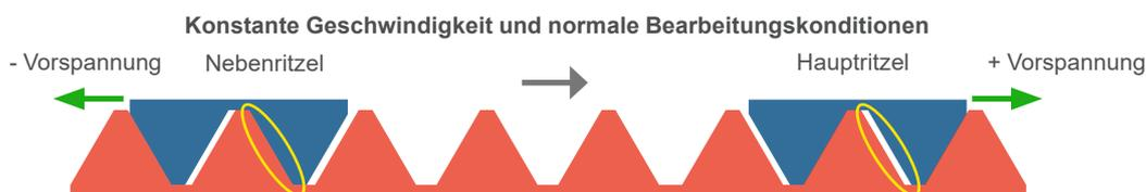
Bei Stillstand, konstanter Geschwindigkeit und während der Bearbeitung kompensiert die Vorspannung das Umkehrspiel. Die Position des Hauptritzeis ist die Vorgabe für das Nebenritzel. Die Zahnstange (rot) bewegt sich.
