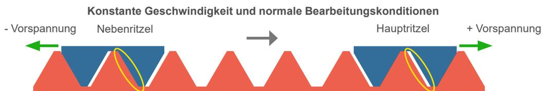
Bei Stillstand, konstanter Geschwindigkeit und während der Bearbeitung kompensiert die Vorspannung das Umkehrspiel. Die Position des Hauptritfels ist die Vorgabe für das Nebenritzel. Die Zahnstange (rot) bewegt sich.
