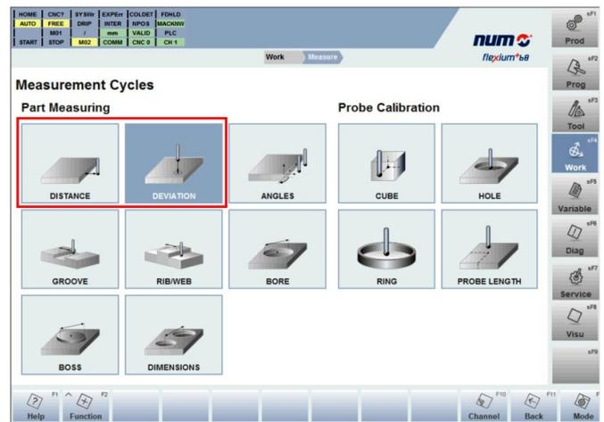
Une fois qu'un cycle de mesure a été lancé par l'opérateur, tout le positionnement du palpeur peut être géré automatiquement par la CNC. Le stylet du palpeur est entièrement protégé contre toute collision avec la pièce dans l'environnement de travail, toute erreur étant signalée au système CNC et entraînant un arrêt immédiat. Le logiciel comprend la gestion complète de la fonction RTCP (Rotation Tool Center Point), pour traiter les coordonnées inclinées à l'intérieur du cercle de mesure.
