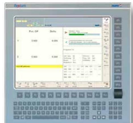
das Maschinenbedienfeld des Typs MP04 von NUM. Die Flexium-Bedienpulte des Typs FS152i ähneln in mechanischer Hinsicht denen der FS151-Reihe und haben auch dasselbe Lochmuster. Sie eignen sich hervorragend zur Realisierung und Bedienung anspruchsvoller, moderner Systeme und gehen mit der Flexium NCK eine ideale Partnerschaft ein.
