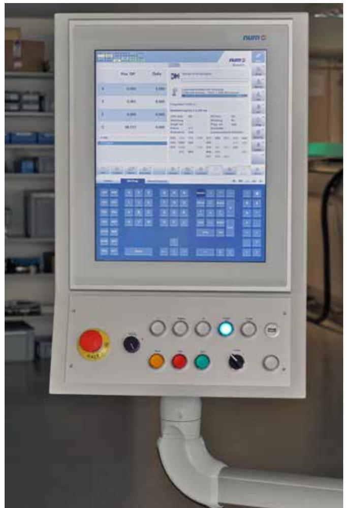
NUM FS192i HMI，辅以 Felastec 内部开发的操作面板。
