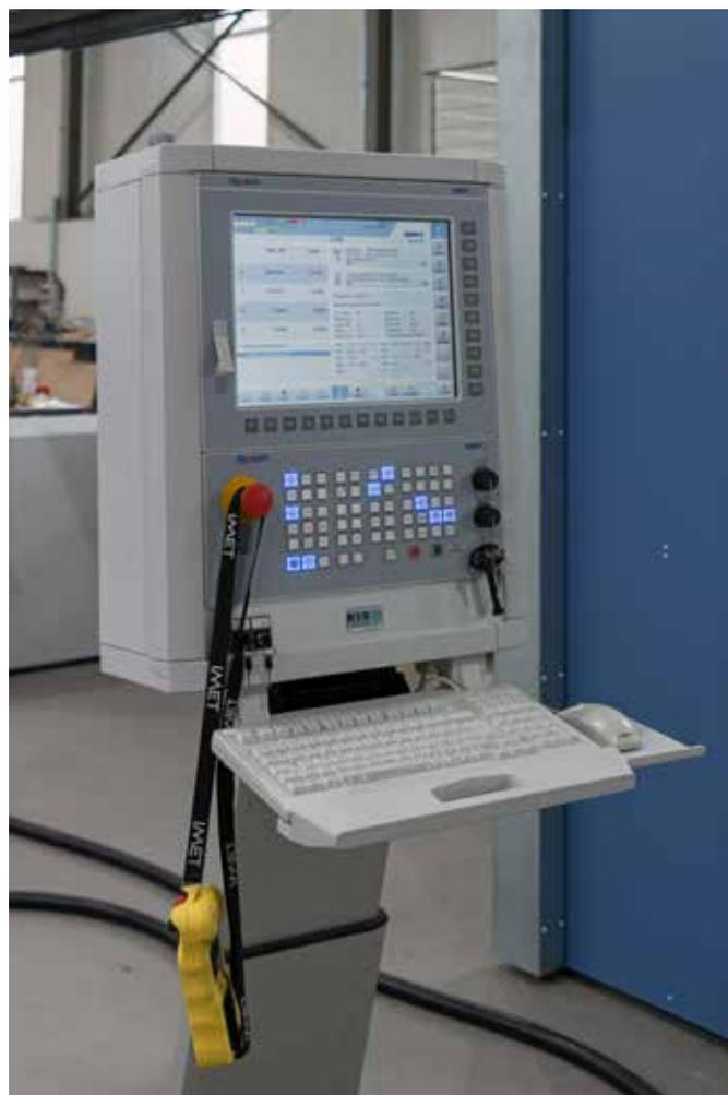
Flexium+ 68 控制系统，配有 NUM 提供的 FS153i HMI 和 MP06 操作面板。
