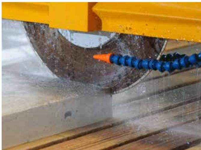
锯片以高达 650 rpm 的速度切割石材，直径最大 1.3m。
