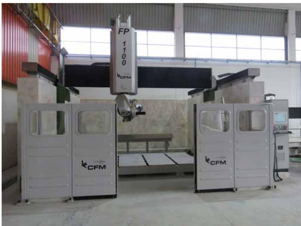
CFM 提供的 5 轴 CNC 龙门机床，配有 NUM 控制器。
