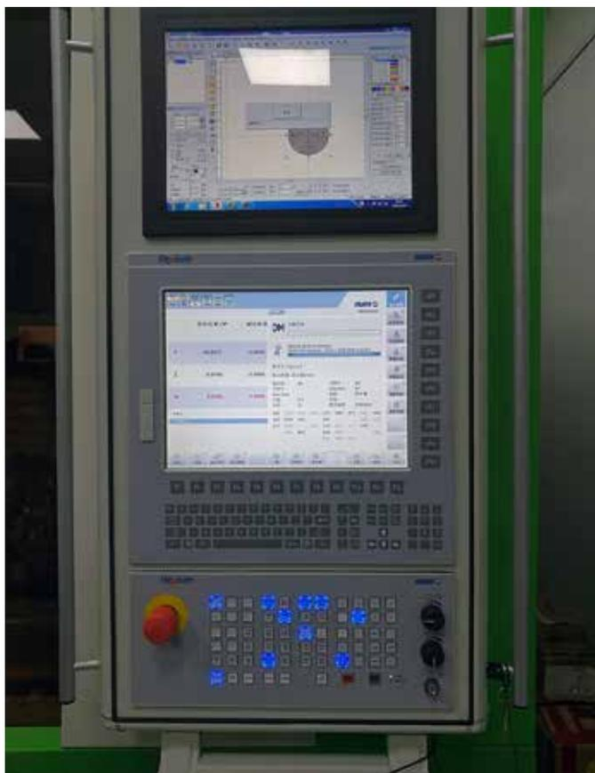
ML125 加工中心的 HMI 基于 NUM 的 Flexium 触摸屏技术。
