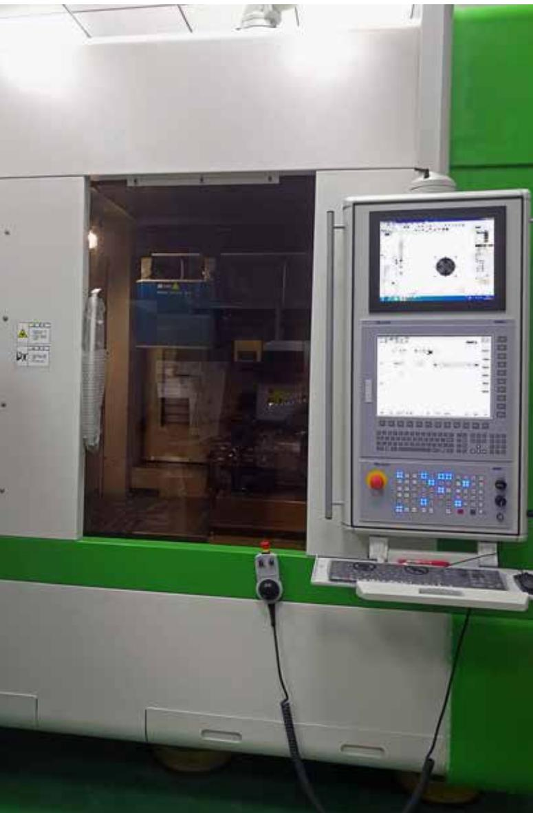
ML125 加工中心完全基于 NUM 的最新一代 Flexium+ 68 CNC 平台。
