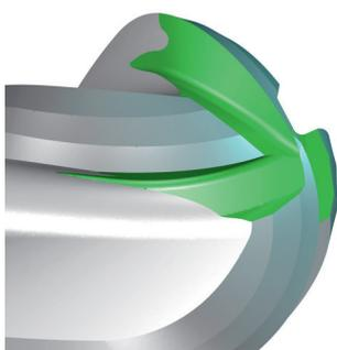
Der Spanwinkel kann im Zentrum und beim Übergang in den Mantel individuell programmiert werden. Mit der Ausspitzung-X lässt sich bei Bedarf auch eine Schutzfase auf die Kugelschneide schleifen.
