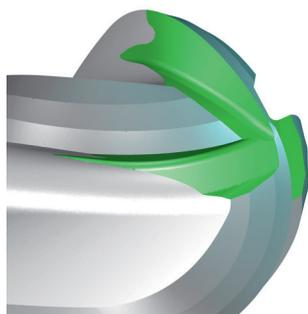
L'angle d'enlèvement des copeaux peut être programmé individuellement pour le centre ou pour la transition vers l'enveloppe. L'amincissement X permet, si nécessaire, de meuler une lèvre K-land de protection sur l'arête de la goujure.
