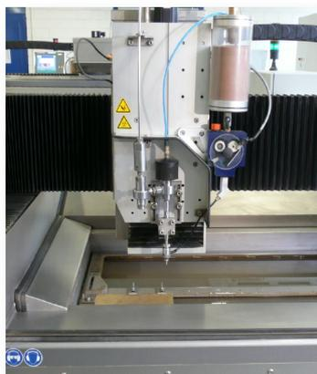
*Durch die Integration von speziellen Kompensationen und einer entsprechenden Mechanik ist diese Maschine in der Lage, Teile im Bereich von  $\pm 0,01$  mm mittels eines Wasserstrahls zu schneiden.*
