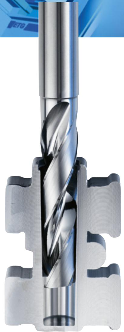
rectifiés par un appointissage en S qui permet de contrôler correctement les copeaux et un flanc concave profilé qui réalise le fond plat. Cet outil est également utilisable pour réaliser des trous de centrage sur des surfaces inclinées. L'angle de point plat réduit dans ce cas les efforts radiaux par rapport aux forets classiques à angle de pointe de 140°.
