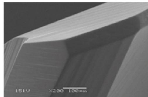
Arête d'un outil spécial grossie 200 fois après polissage avec la technologie MMP Technology®. Des bords d'attaque avec un arrondi d'arête minimum, garantie d'une découpe parfaite.
