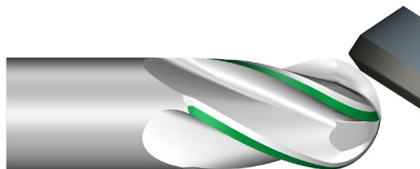
Fig. 7 Meulage avec l'ensemble de la jante d'une meule 11V5 le long de la dépouille sphérique
