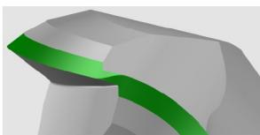
Fig. 1 Centre de la fraise boule avec une arête transversale en forme S
