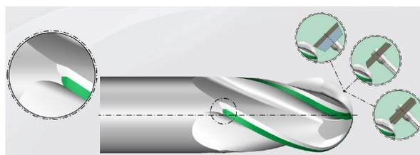
Fig. 6 Meulage perpendiculaire à la surface
