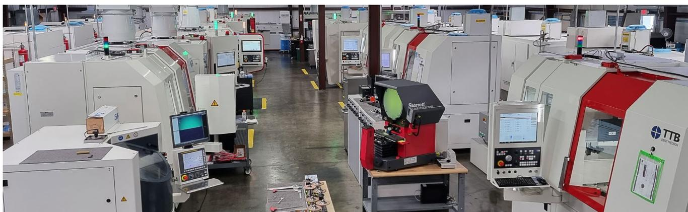
Tool Alliance fait un usage intensif de rectifieuses à commande numérique dans ses installations de fabrication
