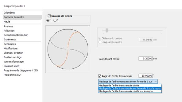
Fig. 3 Fenêtre de définition de l'angle de l'arête transversale
