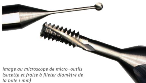
Image au microscope de micro-outils (sucette et fraise à fileter diamètre de la bille 1 mm)
