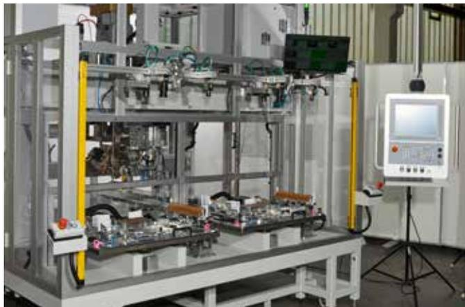
搭载 Flexium+68 控制系统的热压印机，含双滑入式工作台及 8 组质量监测摄像头
