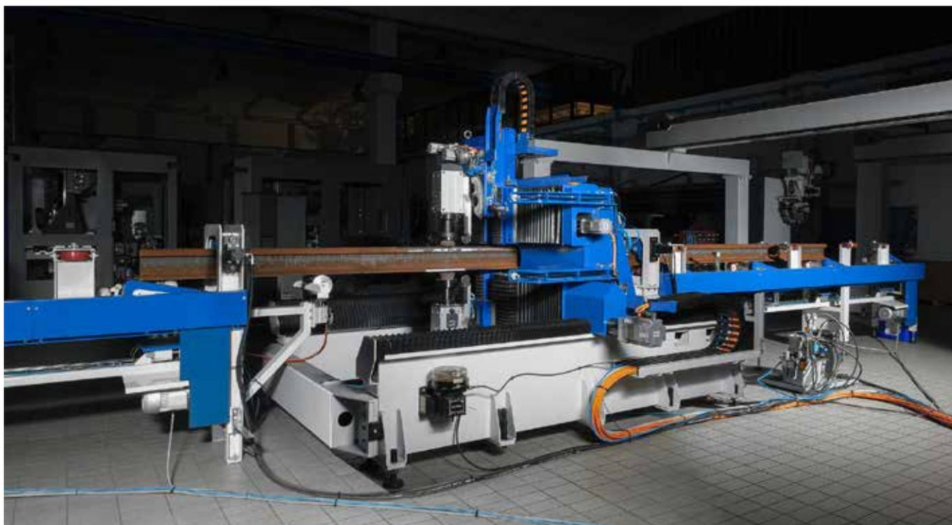
Provide Solution 建造了一个 200 米长的全自动轨道部件焊接设备。
