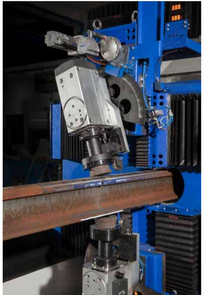
用于清除焊接和打磨残留物的机器完全由 **Provide Solution** 在 **NUM** 的帮助下设计和制造。
