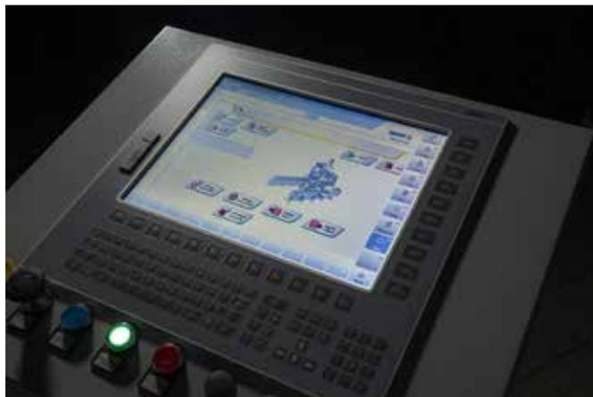
NUM 提供的系统为 Flexium+ 68，配有 MDLUX 系列数字驱动器、单电缆无刷电机和绝对编码器。
