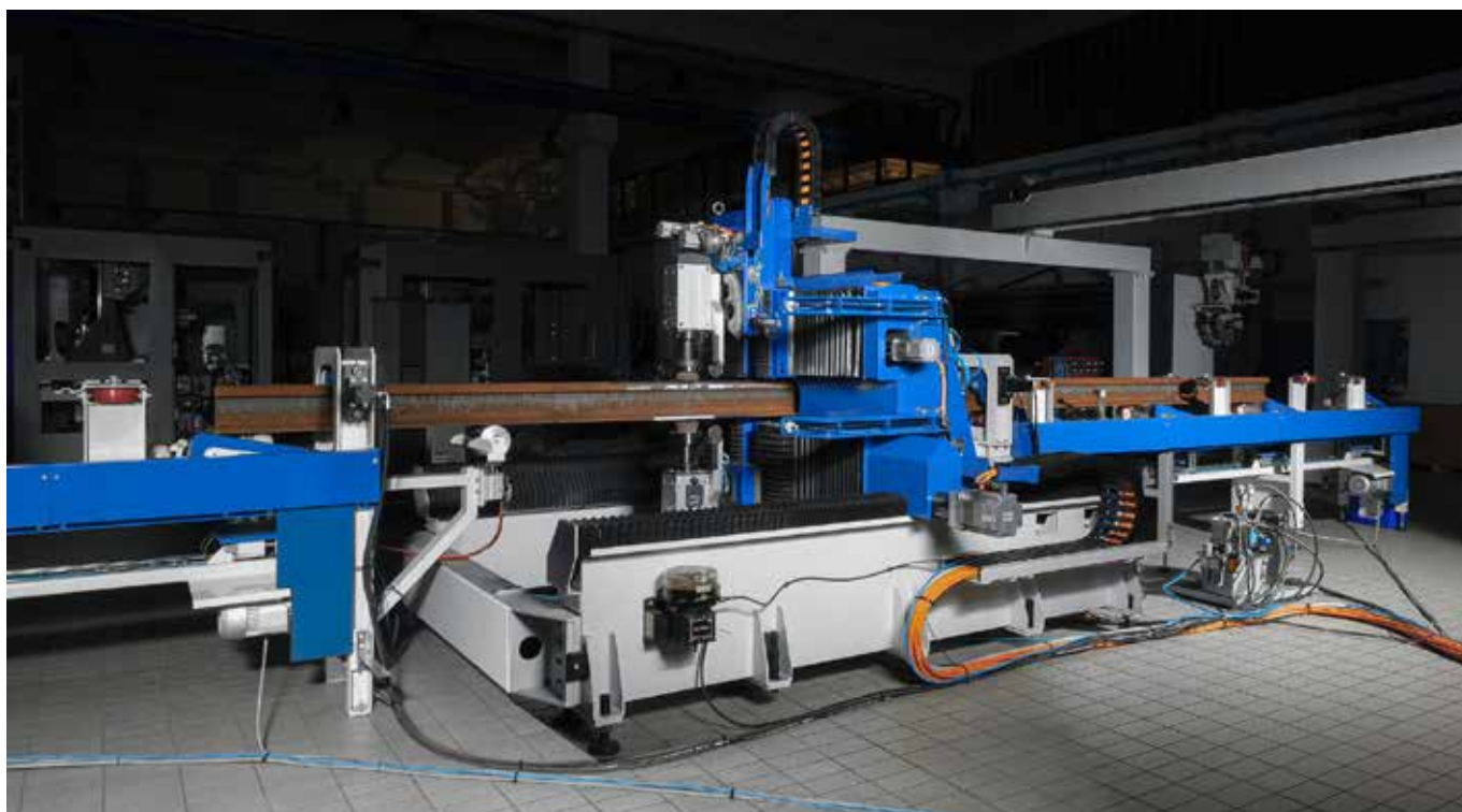
Provide Solution 建立了一個全自動、200 公尺長的軌道零件焊接設備。
