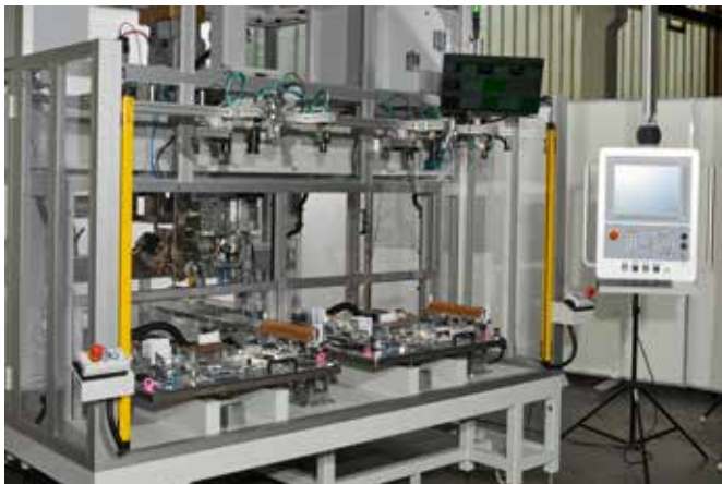
熱燙金機配備 Flexium+68 控制系統。兩個滑入式工作台，包括 8 個攝影機，用於品質監控。
