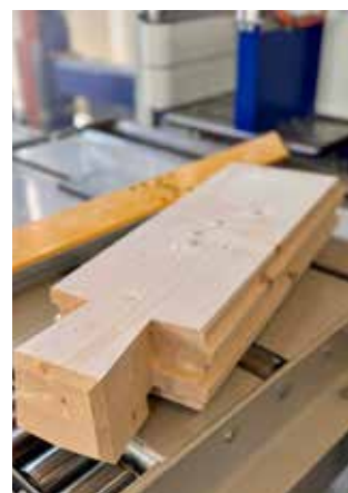
用於建造 Appenzeller Strick 的機械加工工件
