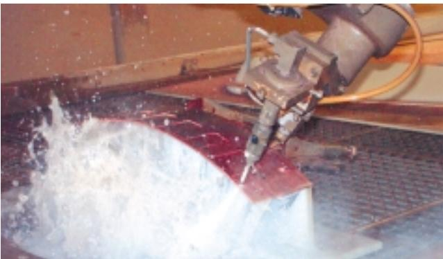
**Für einen sauberen Schnitt muss bei runden Bauteilen die Düse der Kontur folgen – was nur mit einer 3D-Maschine möglich ist.**
