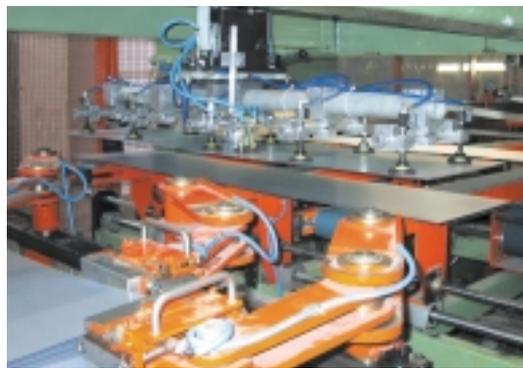
**Variante des 1. Handlingsystems: Bestücken, Befördern und Bereitstellen vom Blech mit zwei Achsen und einem Saugglocke- System (anstelle von 3 interpolierten Achsen).**
