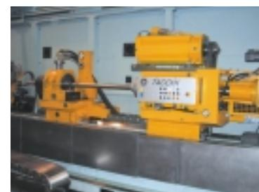
**Zweite Spindel zur Abstützung des Werkstückes beim Drehen oder zur Führung des Werkzeuges beim Ausdrehen**
