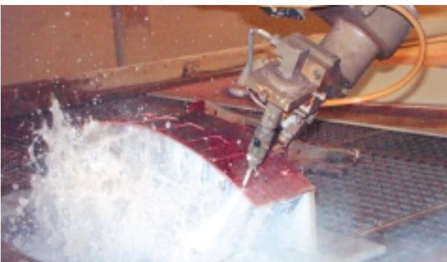
**Pour obtenir une découpe propre de composants ronds, la buse doit suivre le contour, ce que seule une machine 3D permet de faire**
