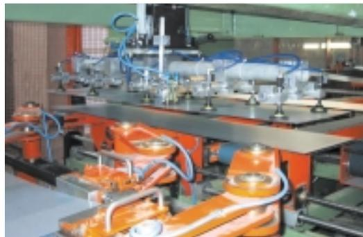
**Une variante du groupe de manutention n°1 permet de réaliser la saisie, le transfert et la mise en place avec deux axes et un système de préhension par ventouses, au lieu de 3 axes couplés.**
