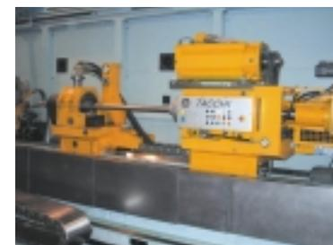
**Seconde broche permettant soit de soutenir la pièce lors des opérations de tournage, soit de soutenir l'outil lors des opérations d'alésage**
