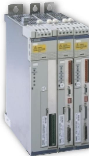
**La bande passante du MDLU2 (typiquement : 3kHz en boucle de courant, 300 Hz en boucle de vitesse et 60 Hz en boucle de position) lui confère une dynamique particulièrement élevée.**
