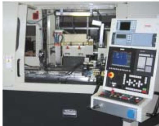
**Il centro di rettifica scelto da Hanchuan Machine Tool è controllato da un Sistem CNC Num Power 1050.**
