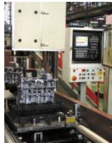
L'obiettivo iniziale era di rendere perenne una macchina, mantenendone le prestazioni. La riscrittura dell'applicativo e la nuova tecnologia installata hanno permesso di ottimizzare i tempi d'accesso alle memorie a bordo della navetta di trasporto e il tempo ciclo della stazione è stato ridotto di circa il 20%! A questo si aggiunge il miglioramento dell'ergonomia senza disagio per gli operatori, poiché la disposizione dei tasti non è cambiata.
