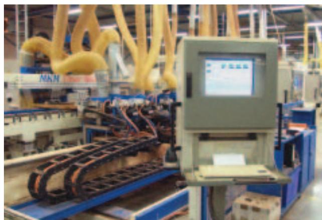
**I cinque controlli numerici Num Power 1080 che pilotano le stazioni dell'impianto sono integrati in una rete TCP/IP e comunicano con uno speciale programma server.**
