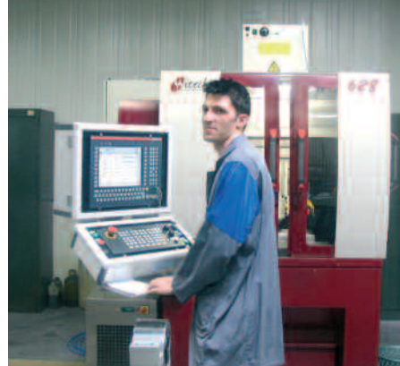
La machine Witech 628 est un centre d'usinage 5 axes particulièrement adapté à la réalisation de pièces de très haute précision.
