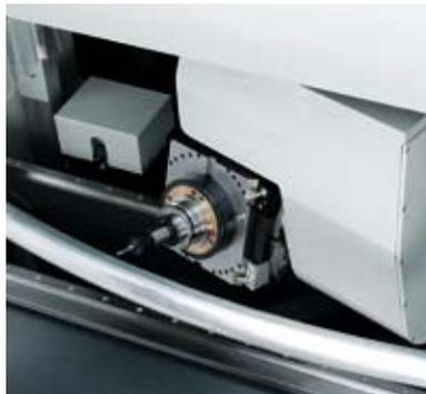
wegungen tadellos beherrscht.“ Die SBZ 151 ist das grösste Modell einer Baureihe aus fünf Maschinen zur Stabbearbeitung. Das sechssachsige Bearbeitungszentrum ist zur rationellen Bearbeitung von Aluminiumprofilen konzipiert, wobei der Verfahrensweg in der X-Achse beliebig lang sein kann.
