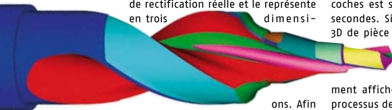
ons. Afin d'obtenir une identification claire, chaque opération d'usinage est représentée dans une couleur propre. Les fonctions zoom et rotation permettent l'observation précise et l'évaluation des plus petits déplacements et des opérations. L'exactitude de la simulation peut être paramétrée individuellement et le modèle 3D peut être mesuré précisément.
