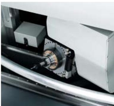
centre d'usinage de barres SBZ 151 du nouveau CNC Axiom Power, qui maîtrise parfaitement les déplacements simultanés de cinq axes. Le SBZ 151 constitue le plus grand modèle d'une gamme de cinq machines servant à l'usinage de barres. Ce centre d'usinage à six axes est conçu pour usiner de façon rationnelle les profilés d'aluminium pouvant avoir une longueur supérieure à six mètres, la course d'usinage dans l'axe X peut être choisi à volonté.
