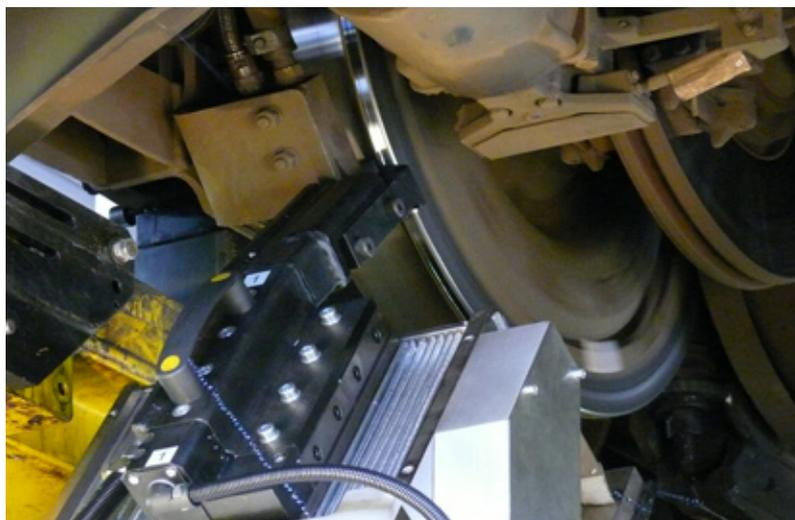
dino e dorso della ruota, oltre alla possibilità di lavorare diversi profili senza dover adattare gli strumenti e processi di tornitura ottimizzati
