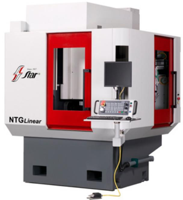
*Tutti gli otto assi sulla nuova macchina rettificatrice per utensili e cutter NTG di Star Cutter Company sono comandati da un unico sistema CNC NUM*
