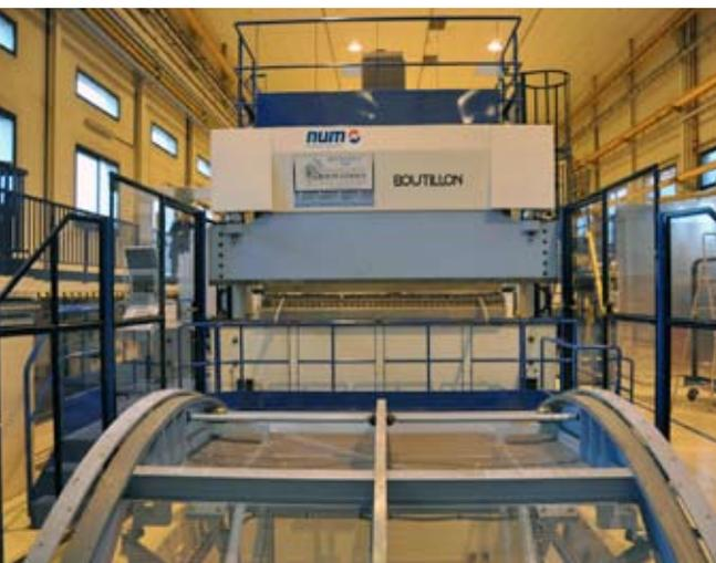
*Vues du réceptacle après pliage et de l'amenage de tôle*
