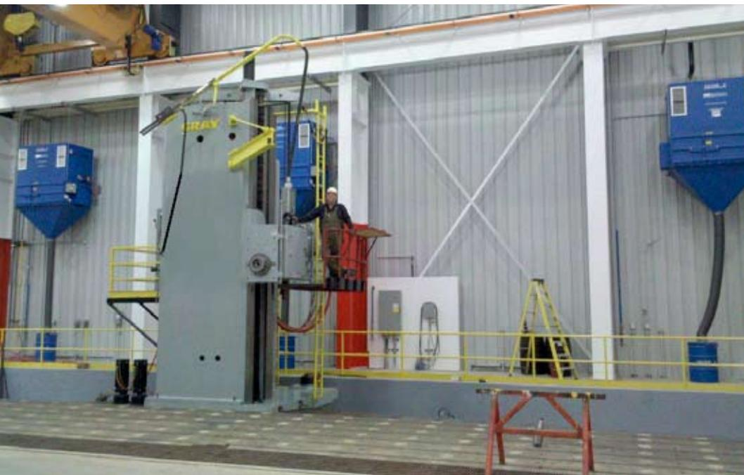
Le pupitre de contrôle FS15x permet d'être à la fois proche de l'outil et connecté au réseau d'entreprise.
