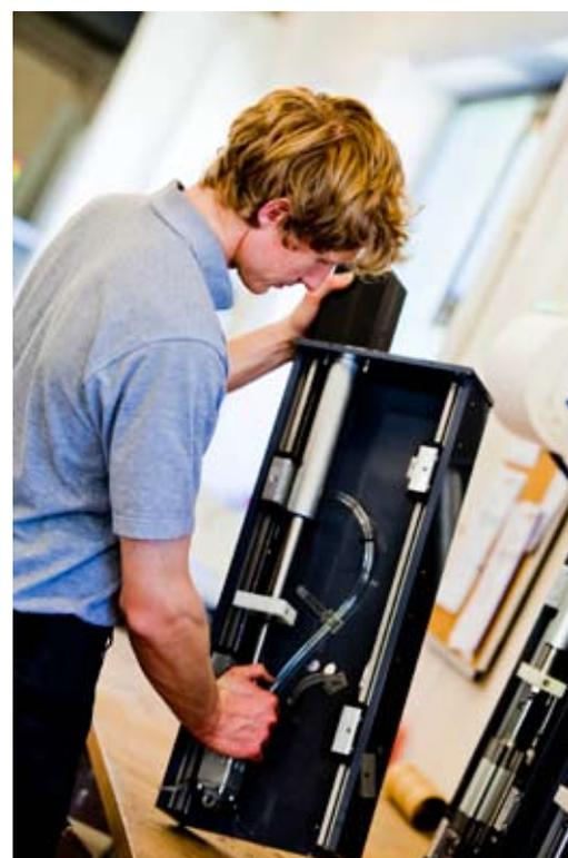
*Zusammenbau der CNC Z-Achse*
