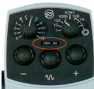
Abb. 1: Handbediengerät mit Handrad HBA-Xd
