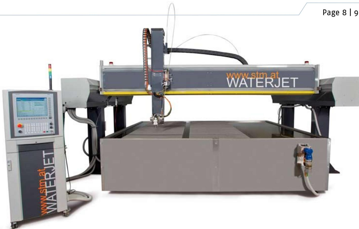
STM 3D Wasserstrahlschneidsystem in Hochportalbauweise mit NUM Bedienfeld FS152i
