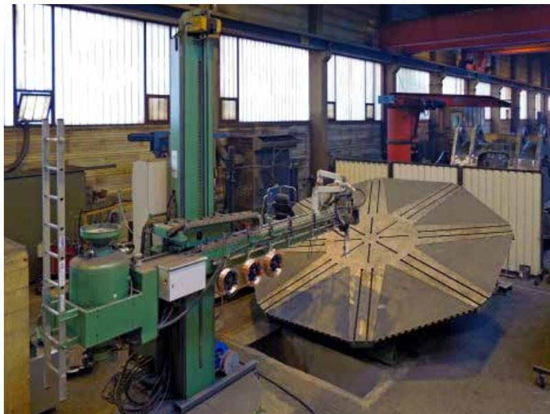
左图：焊工正使用控制杆操作埋弧焊系统
