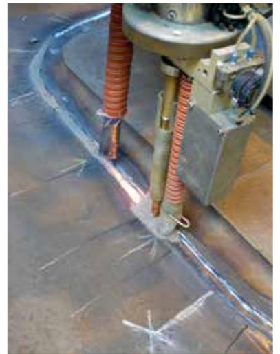
上图：焊接过程中的 SA 系统 - 系统移动至预定义的示教点
