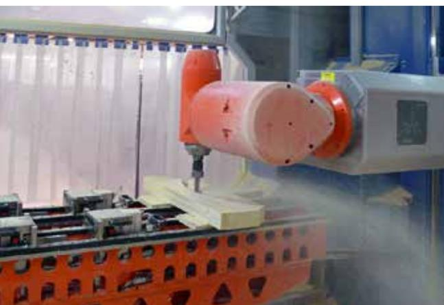
上图：电锯加工过程中的双轴铣削头
