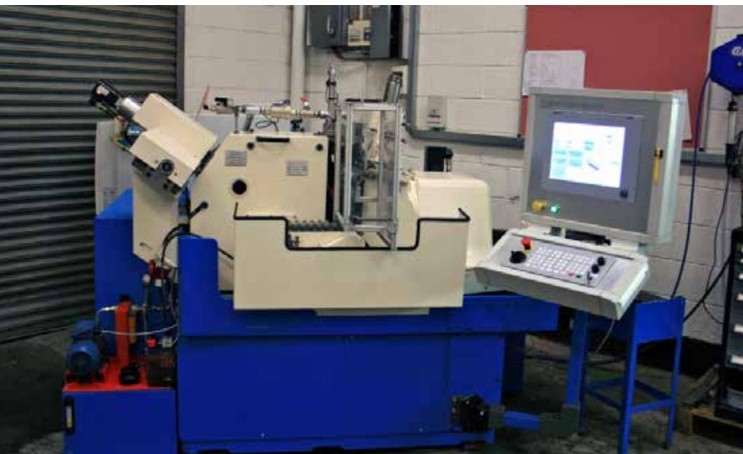
上图：基于原有的液压 / 机械控制 Cincinnati 2-0M 磨床打造 RefreshEng 新型机床
