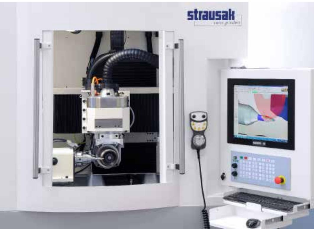
2012 年，**Strausak AG**（现在隶属于 **Rollomatic Holding SA**）推出 **U-Grind**，即配备最新一代 **Flexium CNC** 系统和 **NUMROTOplus** 软件包的新型刀具磨削中心。对 **Strausak** 和 **NUM** 来说，设计 **CNC** 机床及 **CNC** 系统和软件时，高精度和质量始终是最重要的目标。
