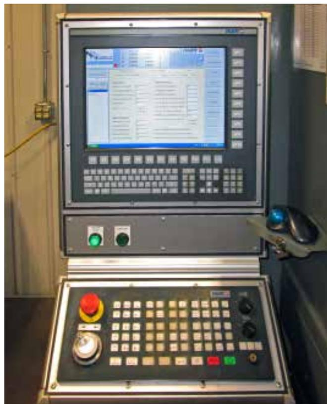
上图：通过 15 英寸屏幕和 NUM 控制面板上的大量功能键简化机床操作
