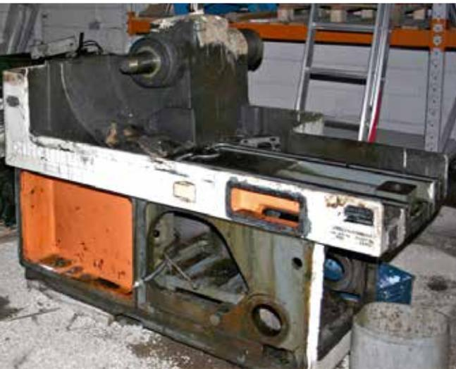
该升级方案改变了 Cincinnati 2-0M 原来的液压和机械修整架构 — 利用固定凸轮和触针控制，使其成为一套基于 CNC 软件的先进系统。根据客户选择，该系统最多可提供七个伺服电机轴。该款新型机床最初针对航空业，提供应用定制软件，以实现机身和飞机引擎专用埋头、圆头和减压紧固件的自动化生产。
