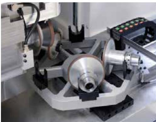
支承面大大减少，此举也广受用户好评。机床配备可从外部加载的 6 刀位圆盘式换刀装置。可从三个方向打开 U-Grind，以便安装和维护。
