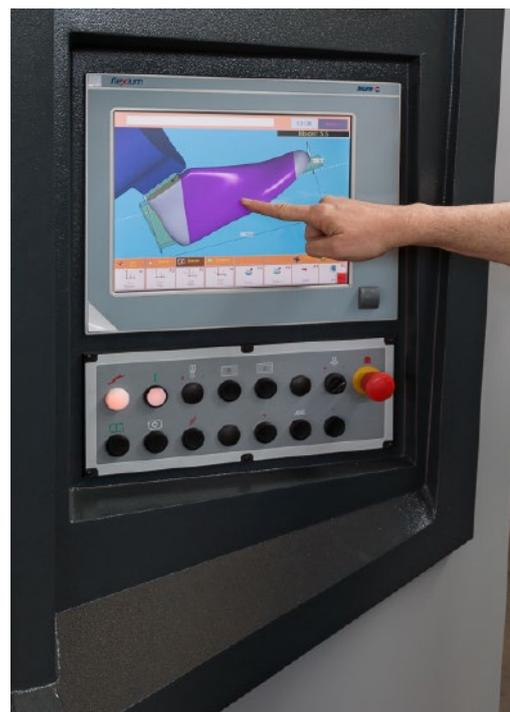
上图：电容式多点触控屏幕，带 **NUM** **CNC** 控制系统 **Flexium** **HMI**
