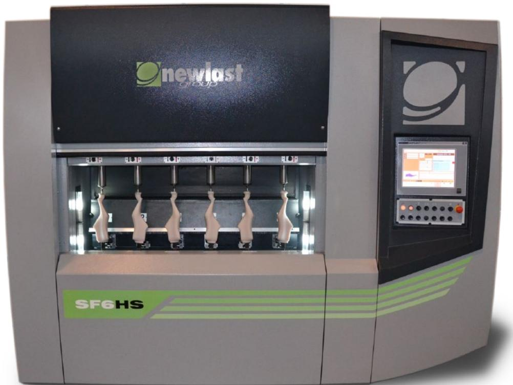
左图：带 **NUM** **CNC** **Flexium** 控制的 **SF6HS** 鞋楦铣床
