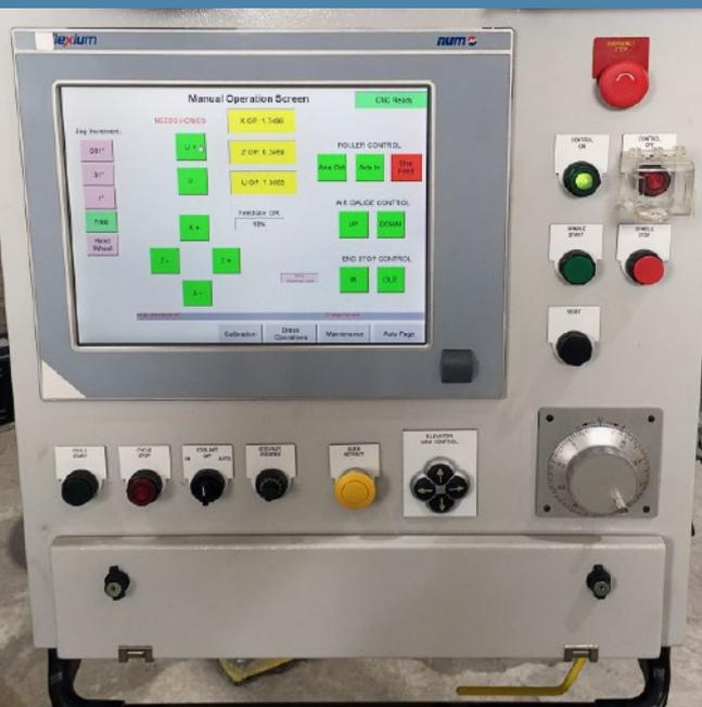
上图：机床的新型控制台纳入带触摸显示屏的 Flexium 操作面板。
