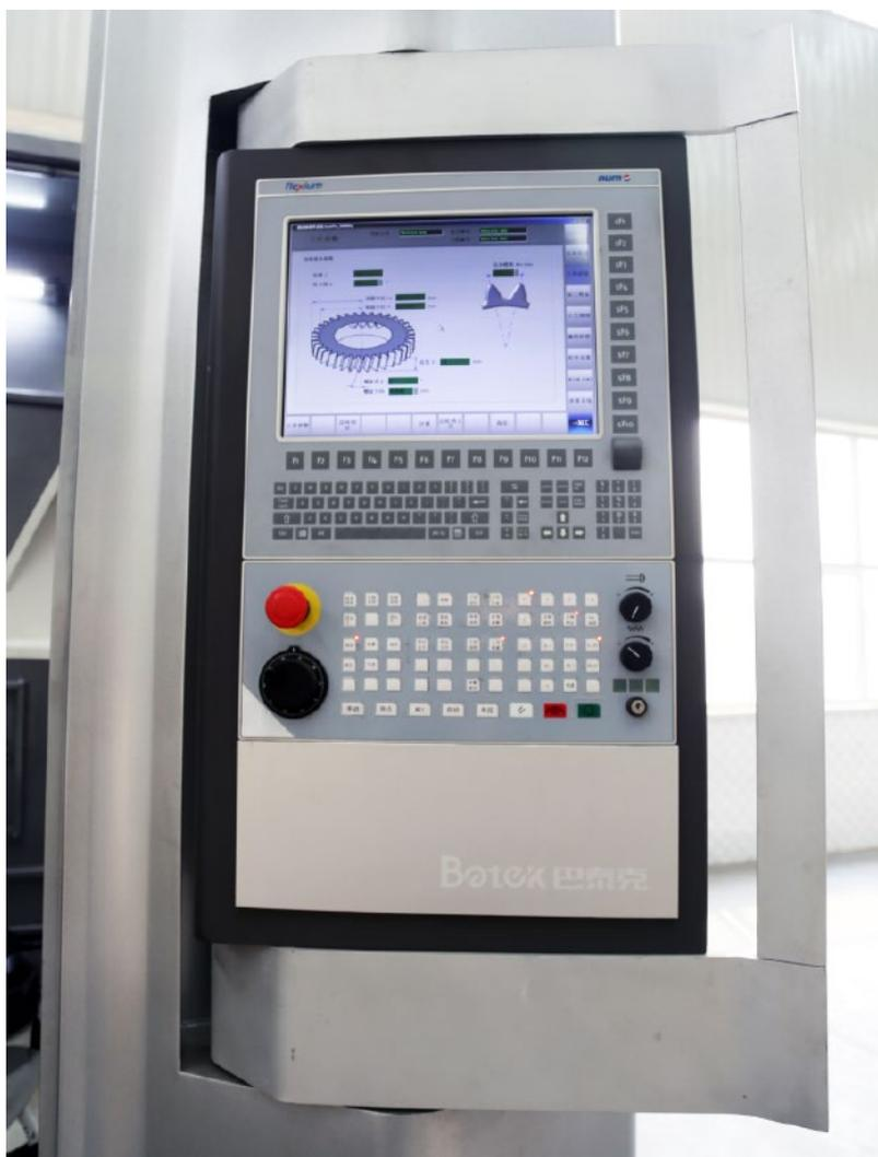
除 I 重新插入齿轮坯料或手动换刀。几乎可对任何类型的齿轮进行切削，包括一些并不常见的类型，如平行齿、人形齿、锥齿和非圆齿轮。为了最大限度地提高加工精度，机床采用干式切削技术，过渡切削齿轮的加工精度可以达到 6 级，成品可达到 3 级。采用干切技术也消除了对切削液的需求，而切削液是加工行业中常见的污染物，需经特殊处理和处置。
