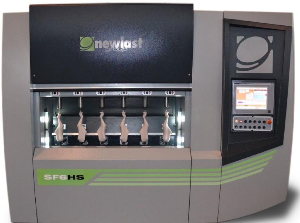
Die SDRF1HS ist eine neue Maschinengeneration, die konzipiert wurde, Schuhleistenmodelle zu fertigen. Durch dieses Produkt reagiert Newlast auf die Anforderungen von Designern und Entwicklern der Schuhhersteller und von Schuhleisten-Produktionsstätten, die vermehrt dazu tendieren,
