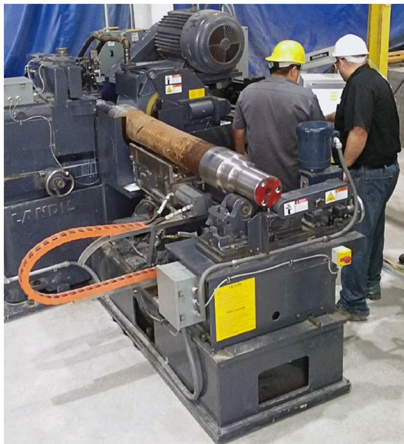
*Links und rechts: Umfangreiche mechanische und elektrische Upgrades auf der Landis Rundschleifmaschine umfassen in neues Flexium CNC-System von NUM.*
