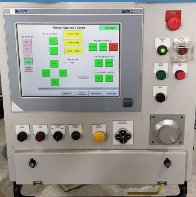
*Oben: Diese spitzenlose Schleifmaschine von Landis wurde mit einem neuen Flexium CNC-System von NUM umfassend mechanisch und elektrisch aufgerüstet.*
