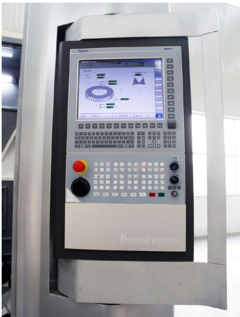
La dentatrice a sei assi Betek YK3132Z può accomodare ingranaggi grezzi fino a 320 mm (12,6 pollici) di diametro. Il suo avanzato sistema CNC può gestire l'interpolazione a cinque assi, permettendo la creazione di complessi profili di ingranaggi regolarmente ed efficientemente. L'intero ingranaggio viene tagliato come parte di un singolo processo, senza rimozioni o reinserzioni intermedie dell'ingranaggio grezzo e senza sostituzione di utensili manuali.
