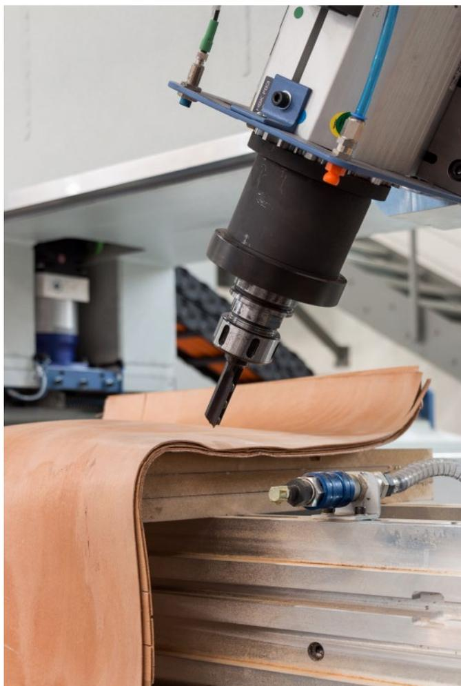
Bearbeitungskopf mit Fräser an einem Werkstück.
