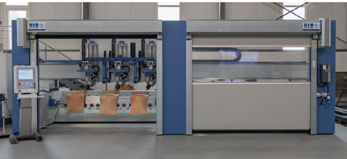
uni\_portal DT in der Montagehalle bei MKM, kurz vor Auslieferung. Die Maschinen von MKM werden beim Endkunden vor Ort von denselben Personen aufgebaut, welche sie bei MKM montieren.
