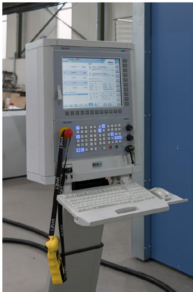
Flexium+ 68 Steuerung mit einem FS153i HMI und MPO6 Bedienpanel von NUM.
