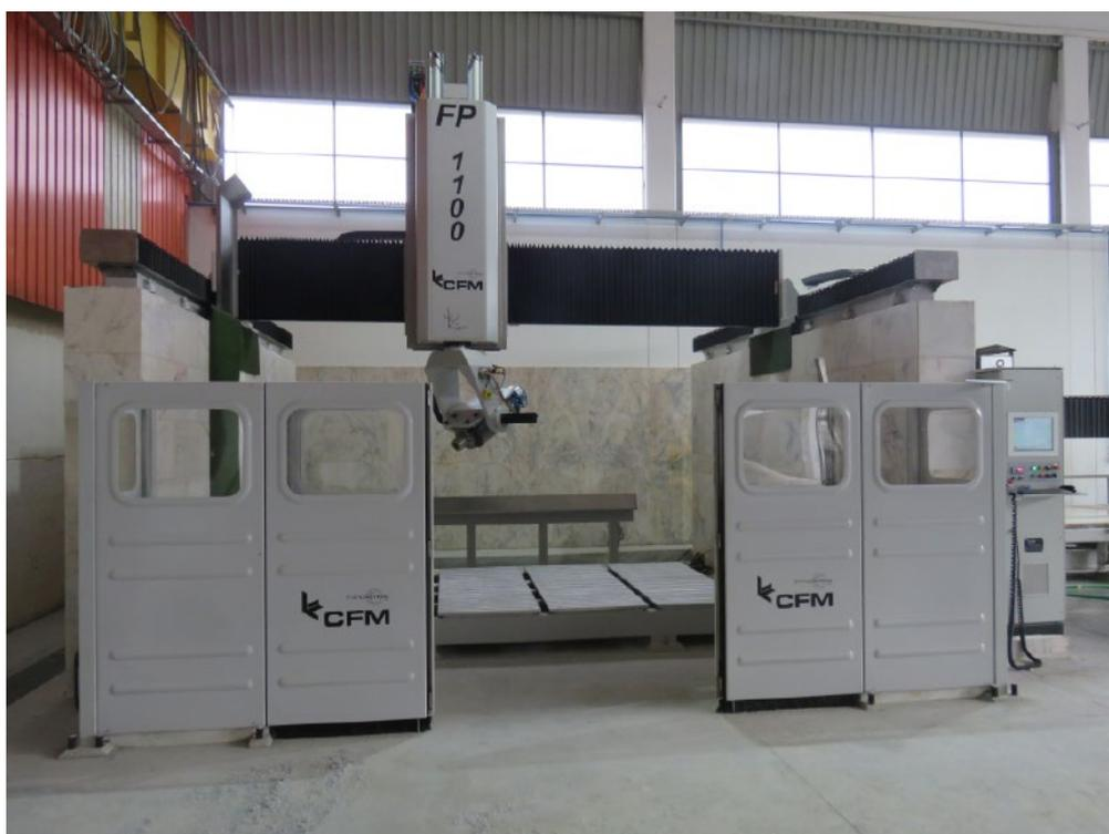
5-Achsen-CNC-Portalmaschine von CFM mit NUM Steuerung.
