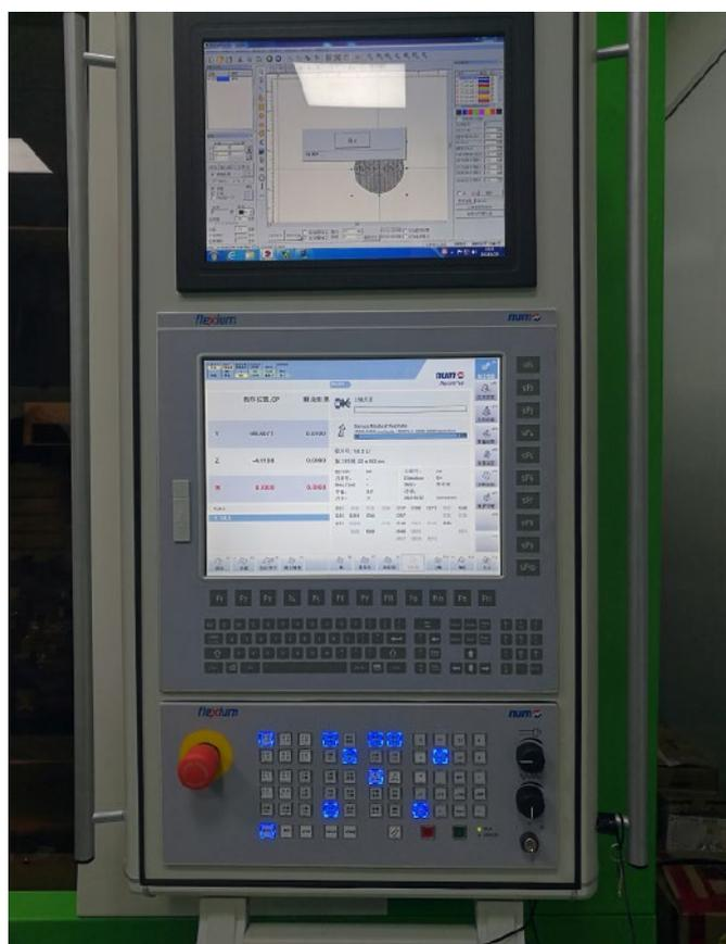
Das HMI des Bearbeitungszentrums ML125 basiert auf der Flexium-Touchscreen-Technologie von NUM.
