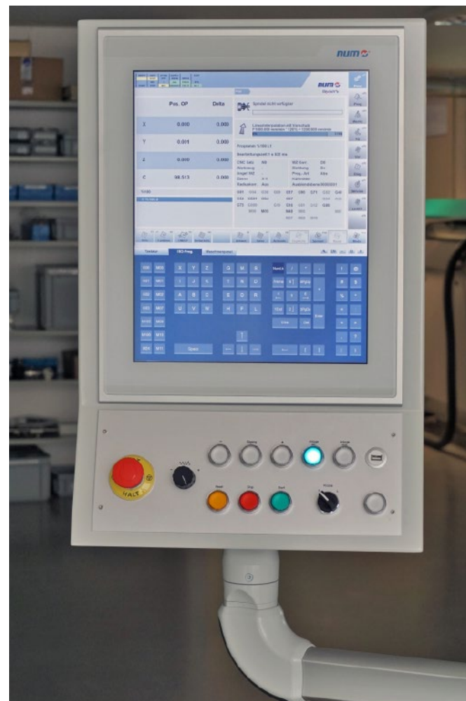
NUMs FS192i HMI, ergänzt mit einem selbstentwickelten Bedienpanel von Felastec.
