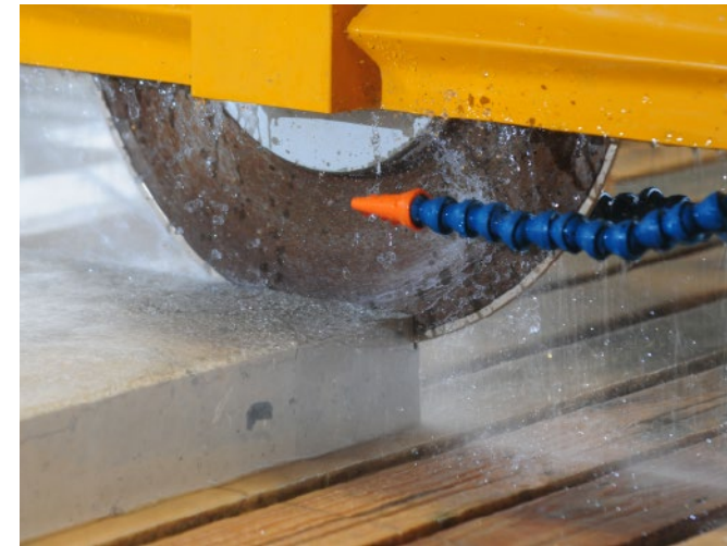
Das Sägeblatt schneidet Stein mit bis zu 650 Umdrehungen pro Minute und hat einen Durchmesser von bis zu 1,3 m.
