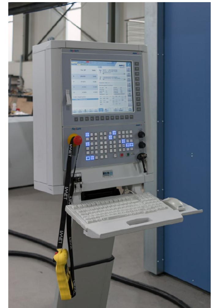
Flexium+ 68 Steuerung mit einem FS153i HMI und MPO6 Bedienpanel von NUM.
