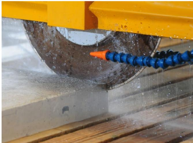
La lame de scie coupe la pierre à 650 trs/min et présente un diamètre jusqu'à 1.3 m.
