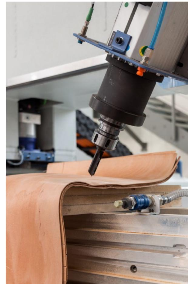
Tête d'usinage RTCP et fraise sur une pièce.
