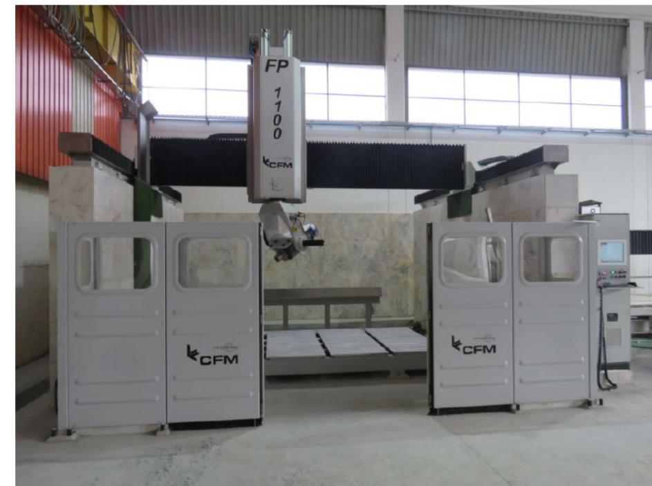
Portique CFM 5 axes équipé d'une commande numérique NUM.
