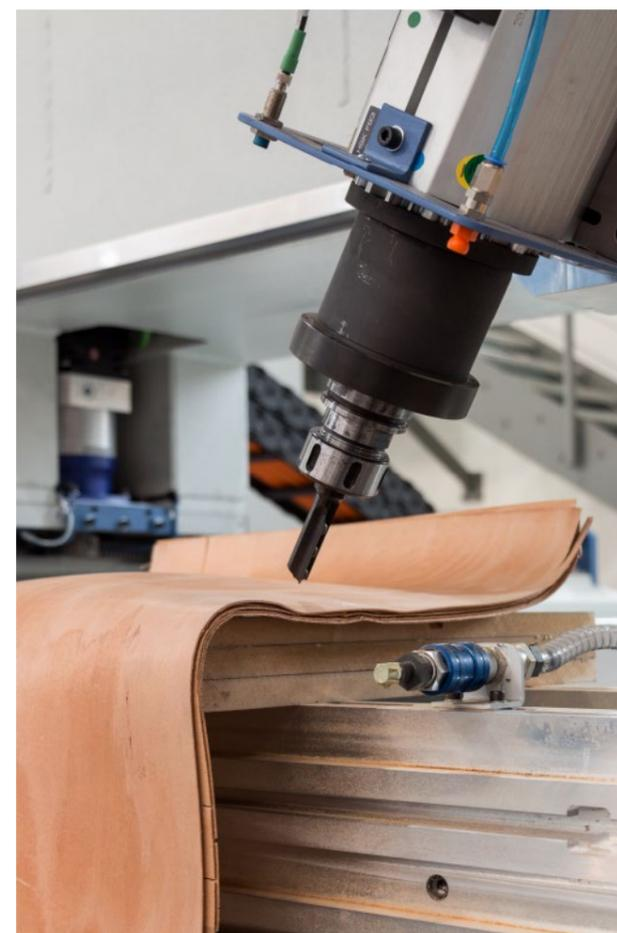
Testa di lavorazione con fresa accostata a un pezzo in lavorazione.
