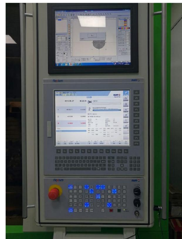
L'interfaccia HMI del centro di lavorazione ML125 si basa sulla tecnologia touch screen Flexium di NUM.
