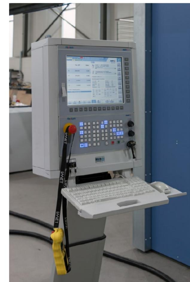
Unità di controllo Flexium+ 68 corredata di una HMI FS153j e di un pannello di comando MPo6 di NUM.
