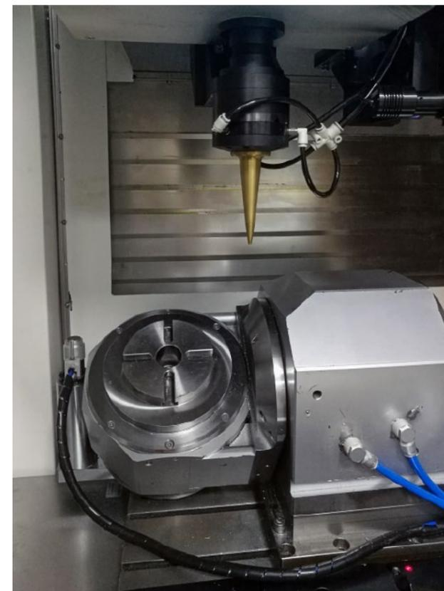
Il centro di lavorazione ML125 è dotato di una doppia testa laser in grado di eseguire tagli ad alta velocità e di alta qualità.
