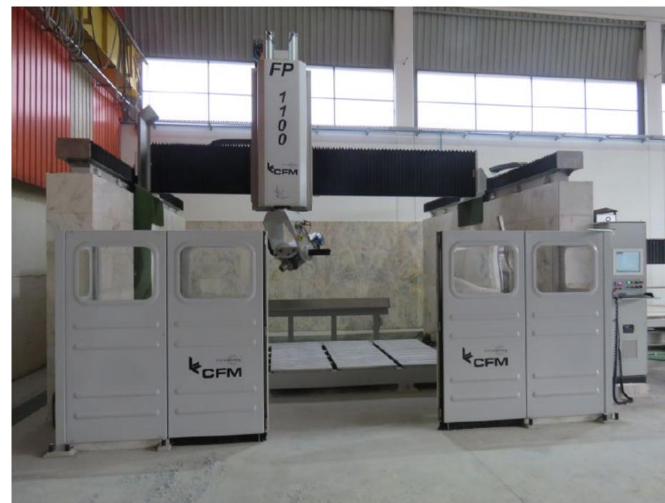
Macchina a portale CNC a 5 assi CFM con sistema di controllo NUM.
