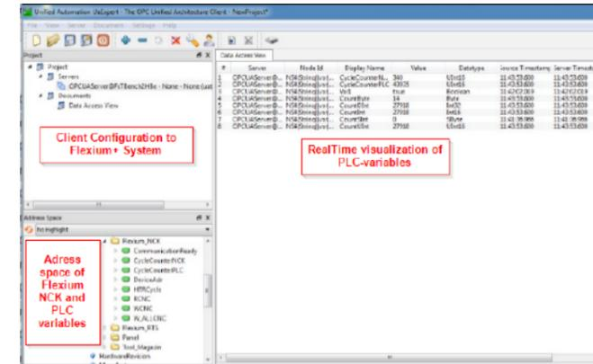
Immagine a sinistra: per fornire l'accesso con Flexium RTS (Server) dopo la configurazione del client, si definisce lo spazio di indirizzamento all'interno dell'ambiente di programma del PLC, specificando quali variabili del PLC devono far parte della comunicazione OPC UA. Nella finestra di visualizzazione dell'accesso ai dati vengono visualizzate le variabili PLC specificate.
