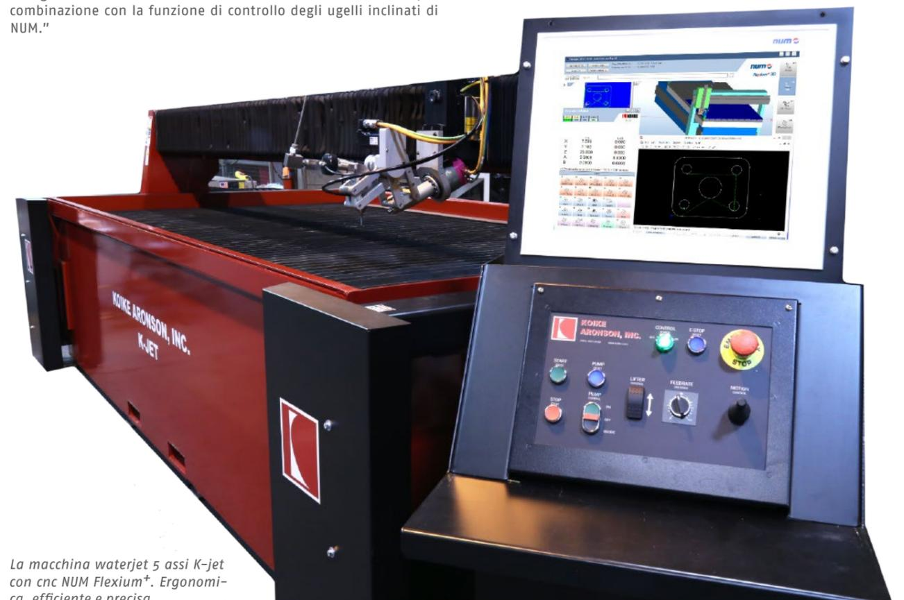
La macchina waterjet 5 assi K-jet con cnc NUM Flexium<sup>+</sup>. Ergonomica, efficiente e precisa.
