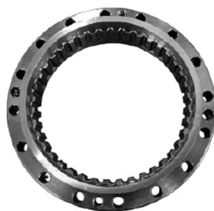
轮廓磨削后的内齿轮。
