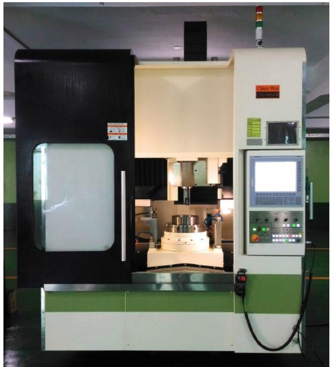
建擘的新型齿轮磨床完全基于 NUM 的新一代 Flexium+ 68 CNC 平台。
