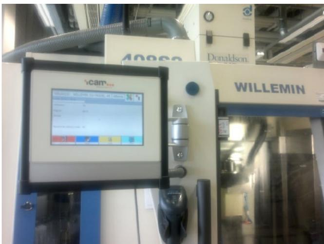
模拟 CNC 机床上的终端，用于连接 **iCAMNet**。
