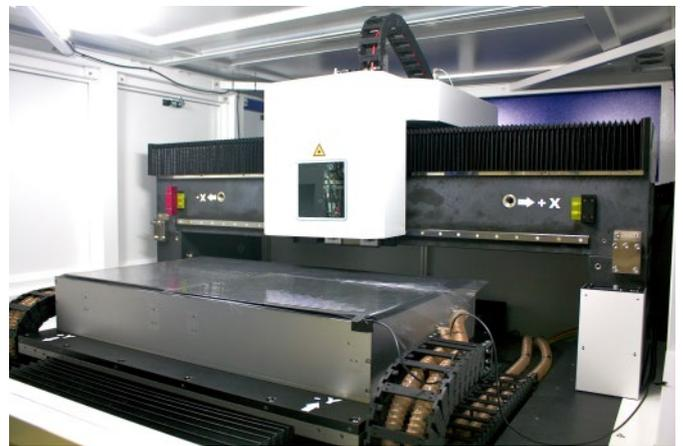
利用 NUM Flexium 软件中独有的“动态操作”功能，精确控制激光切割头与工件之间的间隙。
