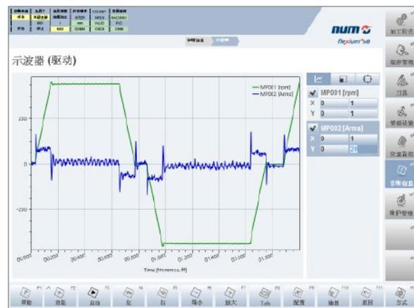
对于所有示波器类型，可通过鼠标键或水平按钮使用缩放 / 平移 / 标尺等功能。可以激活光标，使测量更简单。
