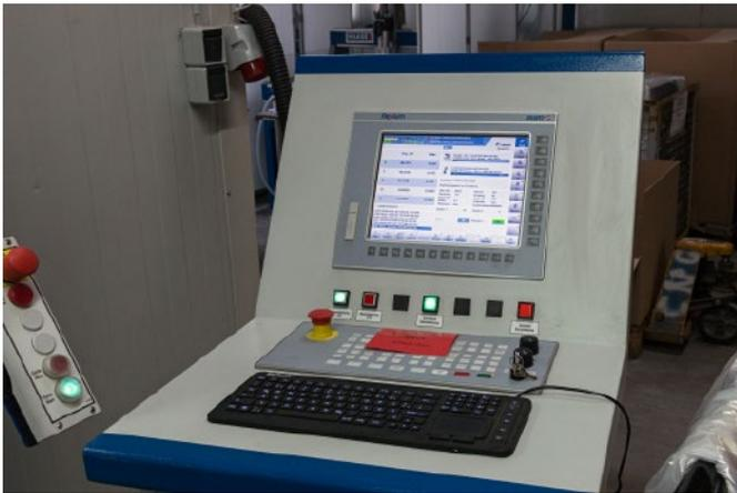
NUM Flexium+ 系统的远程控制面板 FS122 和机床控制面板 MP04。
