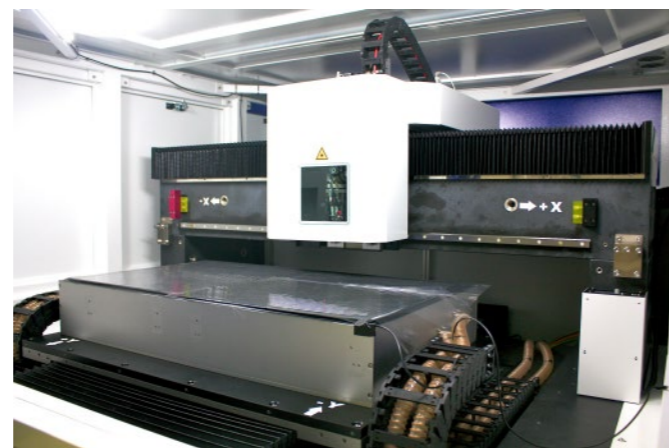
利用 NUM Flexium 软件中独有的“动态操作”功能，精确控制激光切割头与工件之间的间隙。
