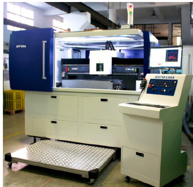
Legend Laser 的新型 SRC-610 精密金属板激光切割系统完全基于 NUM 的 Flexium+ CNC 平台。
