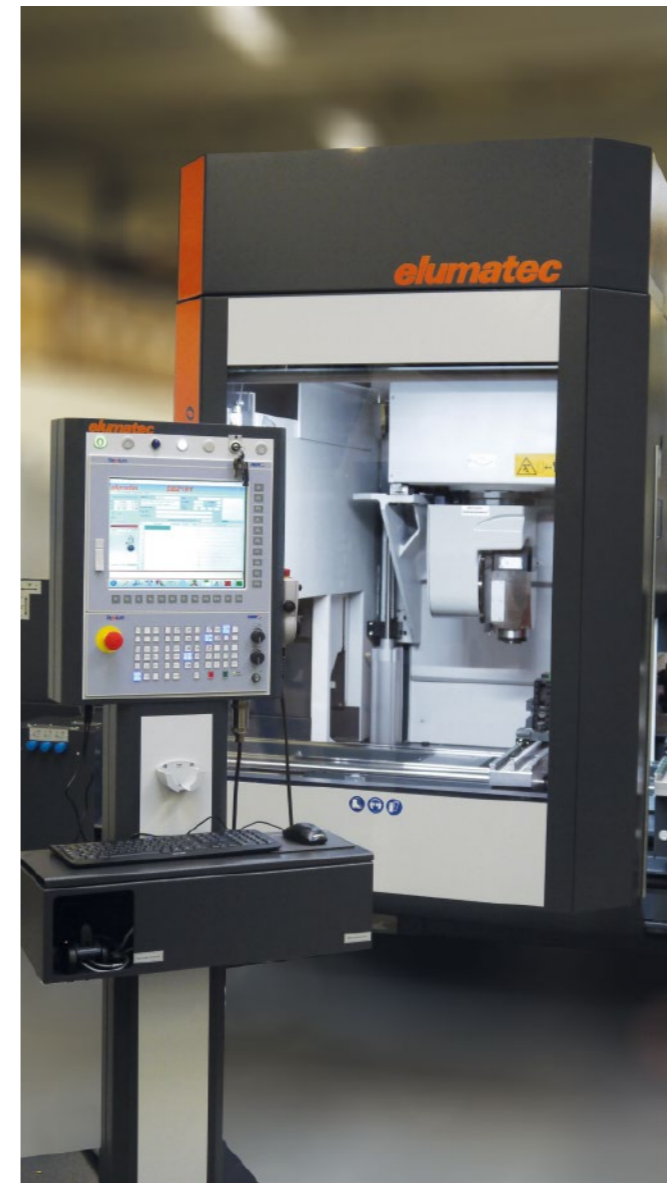
NUM 的 FS154i P2 控制面板（带 SSD 和四核处理器）和 MPO6 机床控制面板。
