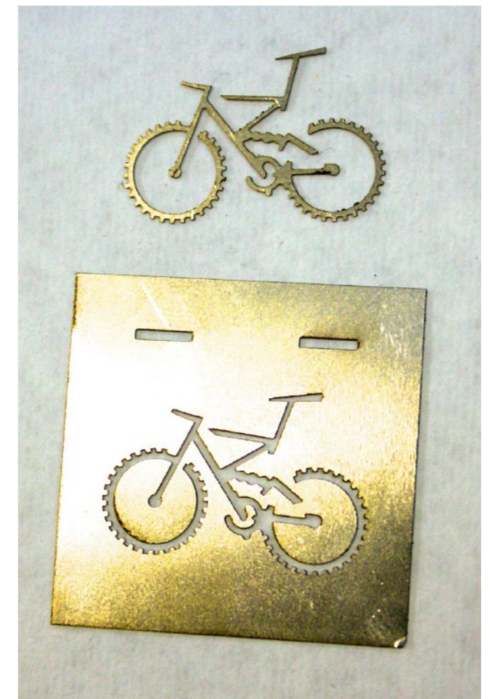
Legend Laser 的新型 SRC-610 系统可将复杂的金属板件切割为 \pm 10 \mu\text{m} 的精度。
