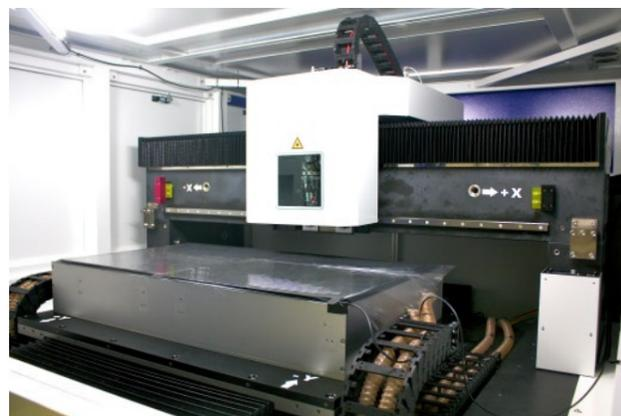
Der Abstand zwischen dem Laserschneidkopf und dem Werkstück wird mit Hilfe der einzigartigen Funktion „Dynamic Operator“ in der Flexium-Software von NUM sehr genau gesteuert.
