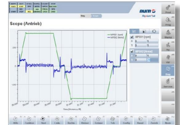
Für alle Oszilloskoptypen stehen Funktionen wie Zoomen/Verschieben/Skalieren über Maustasten oder horizontale Tasten zur Verfügung. Um Messungen noch einfacher zu gestalten, können Cursor aktiviert werden.
