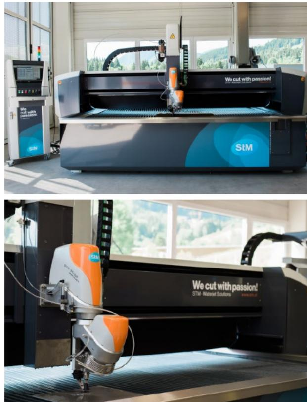
Wasserstrahlschneidmaschine der Firma Stein-Moser.
