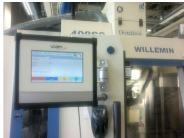
Terminal an einer analogen CNC-Maschine, um diese mit iCAMNet zu verbinden.
