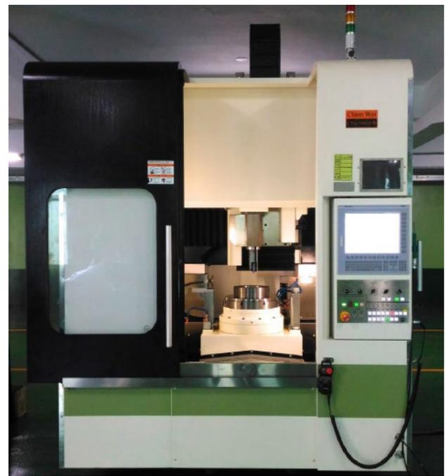
Die neue Verzahnungsschleifmaschine von Chien Wei basierend auf der neuesten Generation des Flexium+ 68 CNC-Systems von NUM.
