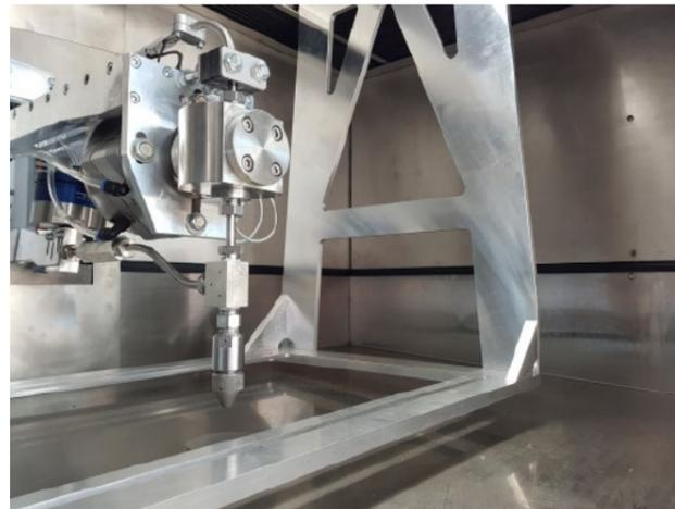
Arbeitsraum der NOVAJET-Wasserstrahlschneidanlage.
