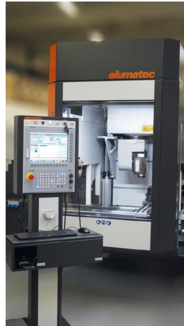
FS154i P2 Bedienpanel (mit SSD und Quadcore Prozessor) sowie MPO6 Maschinenbedienfeld von NUM.
