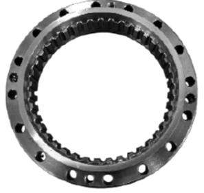
Ein Innenzahnrad nach dem Profilschleifen.
