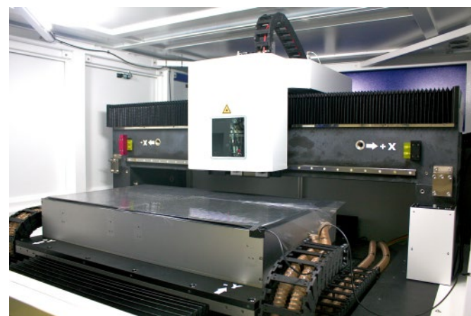
La distance entre la tête de découpe laser et la pièce à usiner est contrôlée avec une grande précision grâce à la fonction 'Opérateurs dynamiques' du logiciel Flexium+.
