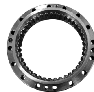
Une couronne intérieure après rectification de profil.
