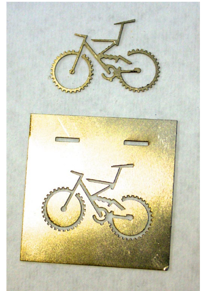
Le nouveau système SRC-610 permet de découper des pièces de tôle complexes avec une précision de plus ou moins 10 microns.
