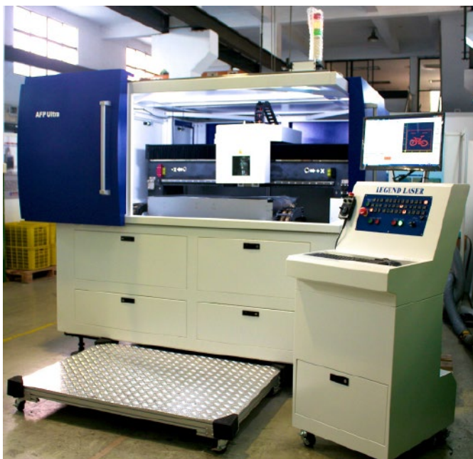
Il nuovo sistema di taglio laser di precisione per lamiera SRC-610 di Legend Laser si basa interamente sulla piattaforma CNC Flexium+ di NUM.
