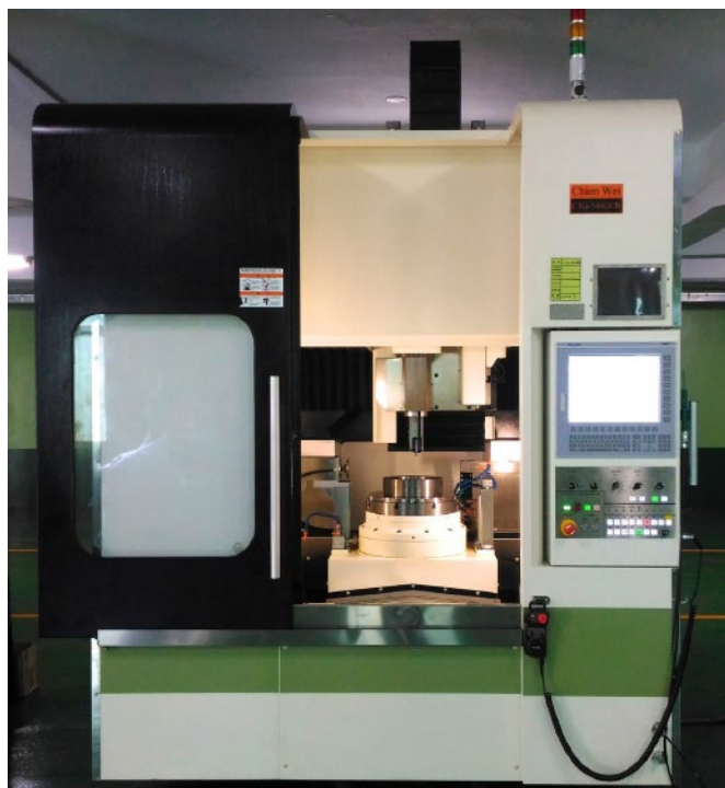
La nuova rettificatrice per ingranaggi di Chien Wei si basa interamente sulla piattaforma CNC Flexium + 68 di ultima generazione di NUM.
