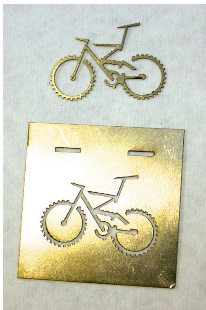
Il nuovo sistema SRC-610 di Legend Laser è in grado di tagliare pezzi di lamiera complessi con una precisione di più/meno 10 micron.
