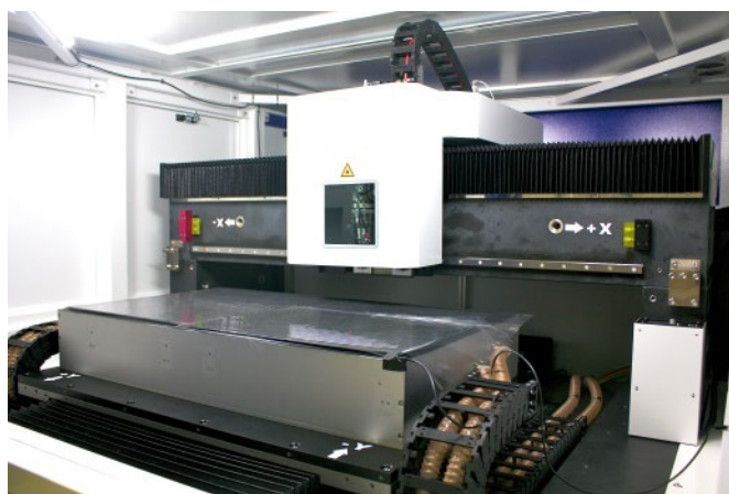
La distanza tra la testa di taglio laser e il pezzo in lavorazione viene controllata con estrema precisione, utilizzando una funzione unica di "operatore dinamico" nel software Flexium di NUM.
