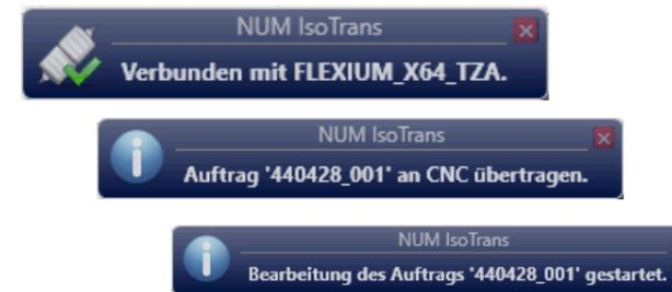
Messaggi di stato delle attuali fasi del processo tramite "Balloon Tips."
