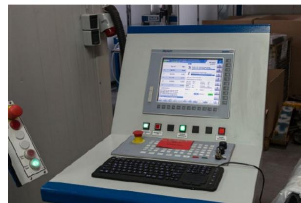
Pannello di controllo remoto FS122 con pannello di controllo macchina MPO4 del sistema NUM Flexium+.
