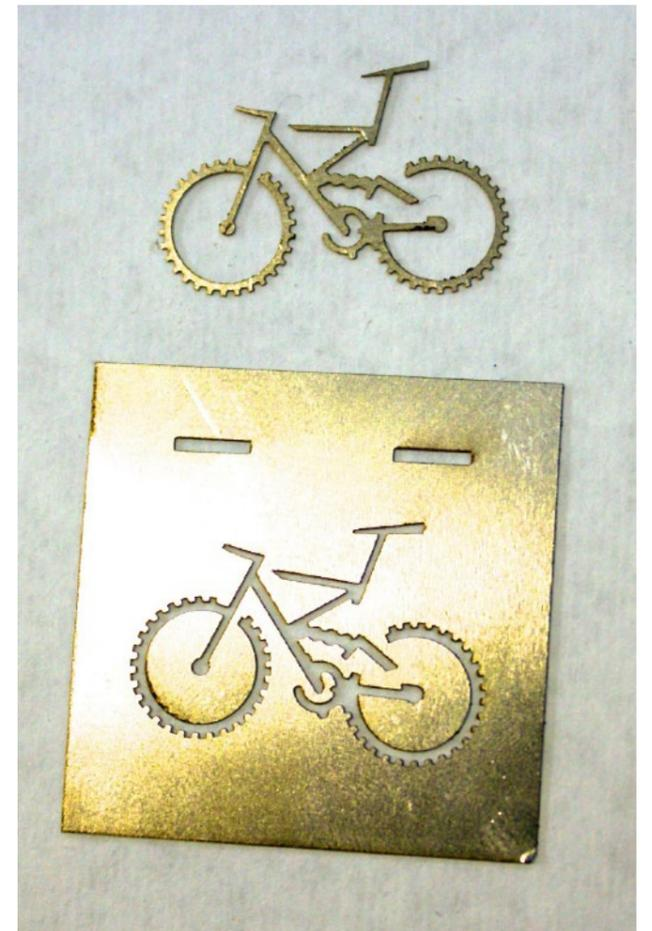
Il nuovo sistema SRC-610 di Legend Laser è in grado di tagliare pezzi di lamiera complessi con una precisione di più/meno 10 micron.
