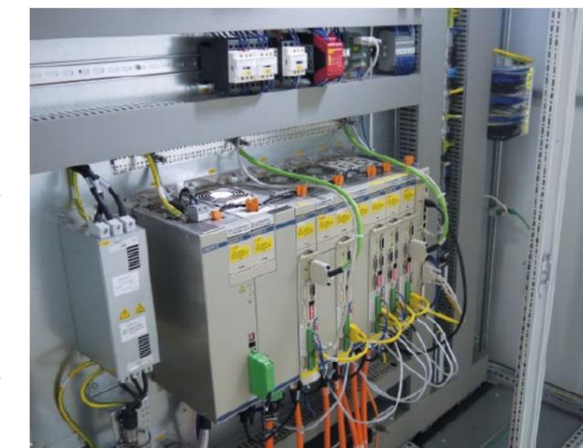
Vista dettagliata dell'armadio elettrico: Sistema CNC Flexium+ 68 CNC con NUMDrive X con soluzione di sicurezza integrata.
