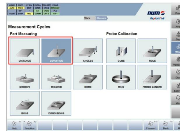
*Der neue Software-Assistent von NUM ermöglicht den Bedienern von CNC-Werkzeugmaschinen die einfache Handhabung von Tastermessungen an Teilen und Werkzeugen.*
