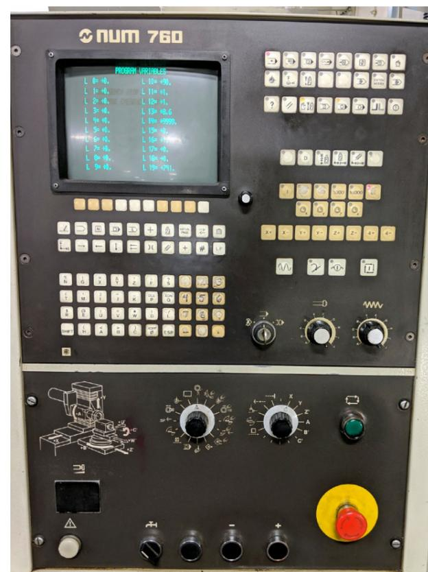
generation von NUM, und den Austausch der Antriebe und Motoren aller fünf Achsen durch digitale Servoantriebe NUMDrive X und neue bürstenlose Servomotoren von NUM.
