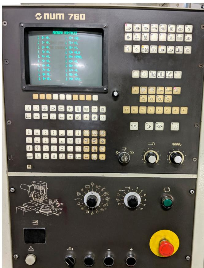
l'occurrence, la société a recommandé de passer au système CNC Flexium+ 68 de dernière génération de NUM et de remplacer les variateurs analogiques et les moteurs des cinq axes par les nouveaux des variateurs numériques NUMdrive X et leurs moteurs brushless associés.
