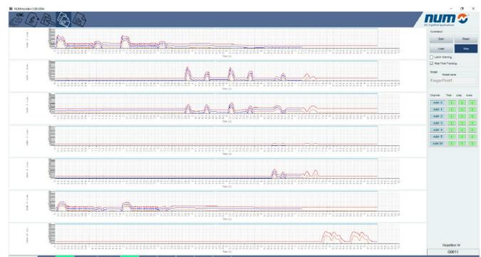
Exemple d'une machine où 7 axes sont surveillés. Bleu : valeur moyenne du courant des axes mesurés lorsque la machine est neuve et testée, Rouge : courbes des enveloppes minimales et maximales
