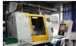
在 ALMÜ 的机床园区使用 NUMROTO 软件的刀具磨床
