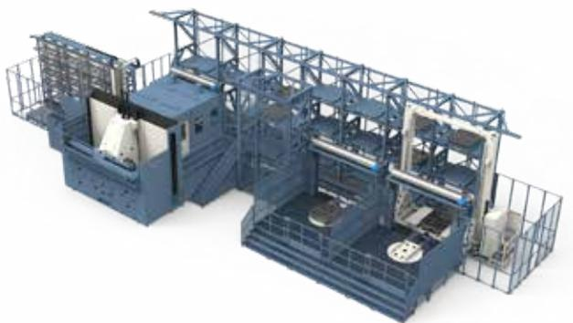
正在安装的 MCM Tank 2600 五轴卧式加工中心的效果图
