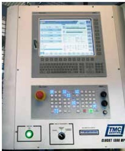
安装在 Tank 1300 MCM 加工中心上配有 NUM Flexium+ 68 CNC 的控制面板
