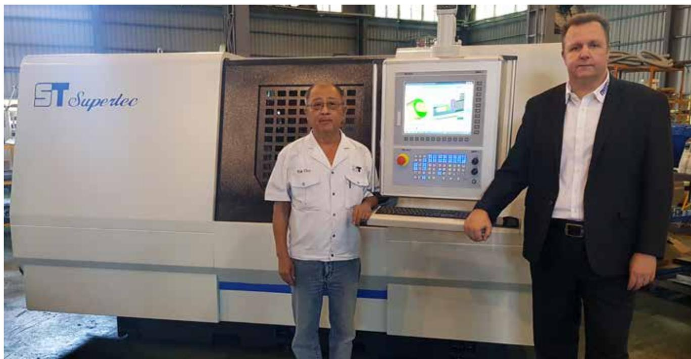
Supertec 最新的插铣型 CNC 外圆磨床基于 NUM 的 Flexium+ CNC 平台。
