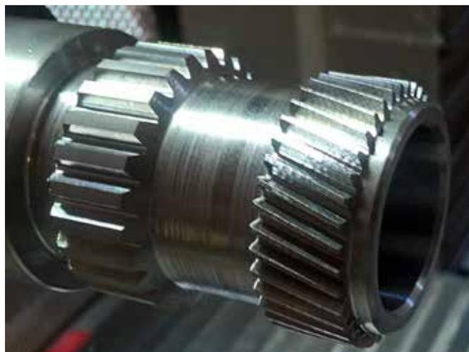
斜齿轮滚刀，直齿轮削片
