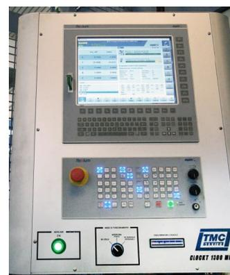
Pupitre de commande de la CN Flexium<sup>+</sup> 68 installé sur le centre d'usinage Tank 1300 MCM
