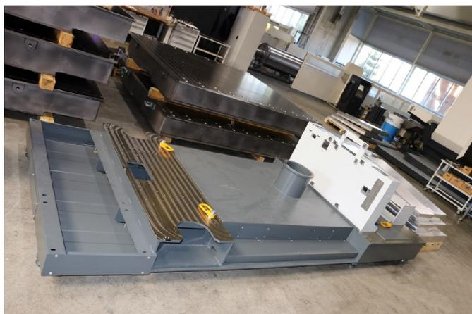
*Typisches Bauteil: Geschweisstes und auf Portalbearbeitungszenter gefrästes Maschinenchassis*
