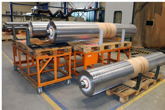
Walzen nach der Bearbeitung durch die Rillenfräsmaschine
