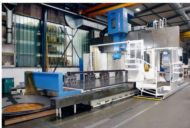
*Portalbearbeitungsmaschine Modumill mit NUM CNC-Steuerung Flexium<sup>+</sup>*
