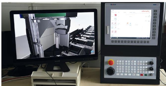
Im System zur virtuellen Inbetriebnahme bei elumatec sind alle Steuerungskomponenten eins zu eins virtuell nachgebildet. Auf dem Bildschirm zu sehen ist der Bearbeitungskopf der SBZ 151
