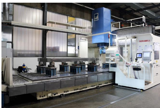
*Portalbearbeitungsmaschine Seramill mit NUM CNC-Steuerung Flexium<sup>+</sup>*
