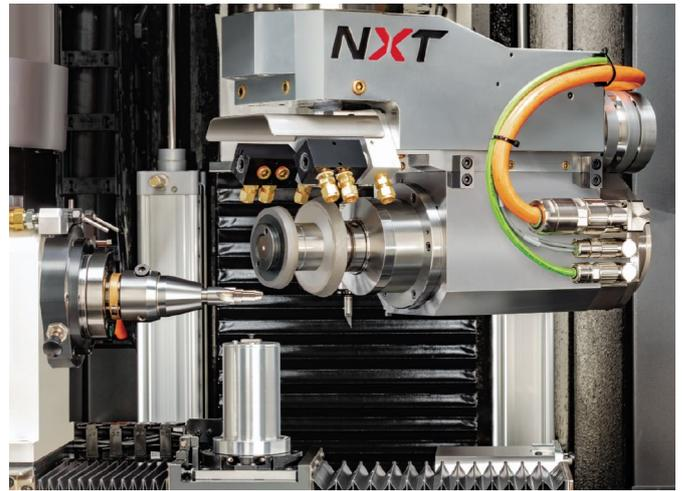
*Alle 5 Achsen der neuen NXT Werkzeugschleifmaschine von Star Cutter werden von einem NUM Flexium+ CNC-System gesteuert*
