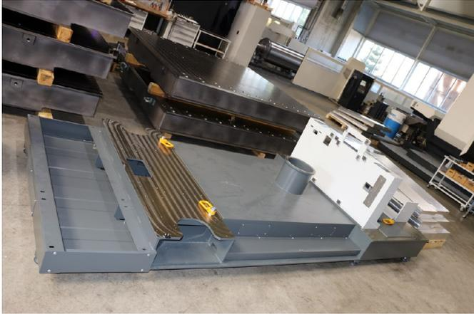
*Composant typique : châssis de machine soudé et fraisé sur centre d'usinage à portique*
