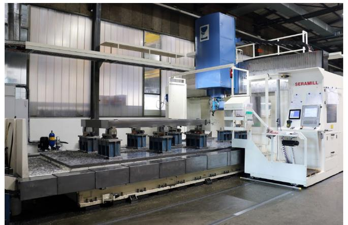
*Centre d'usinage à portique Seramill avec commande numérique NUM Flexium+*
