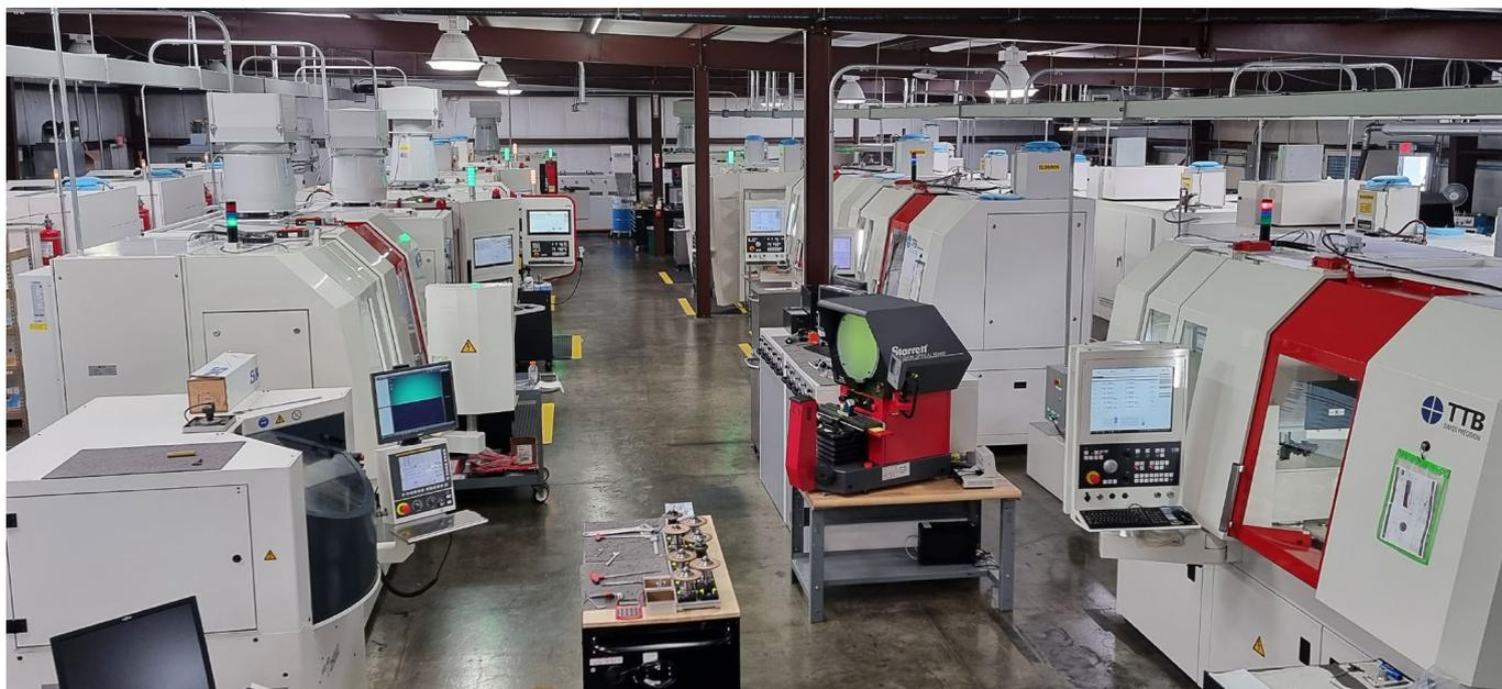
*Tool Alliance fait un usage intensif de rectifieuses à commande numérique dans ses installations de fabrication*
