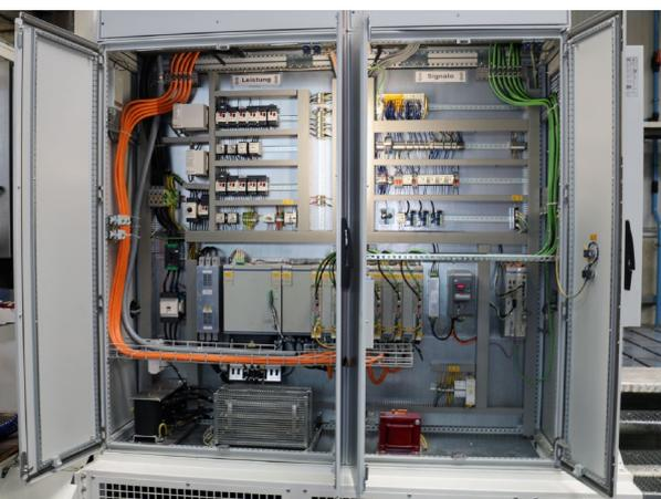
*Armoire de commande de la machine Modumill*
