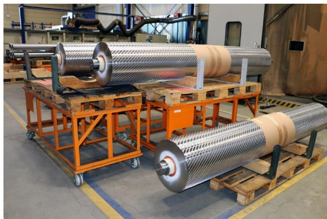
Rouleaux après usinage par la fraiseuse de rainures
