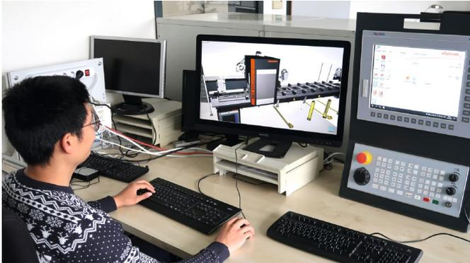
Un collaborateur simule les fonctions d'un SBZ 151 sur le système de mise en service virtuelle chez elumatec AG
