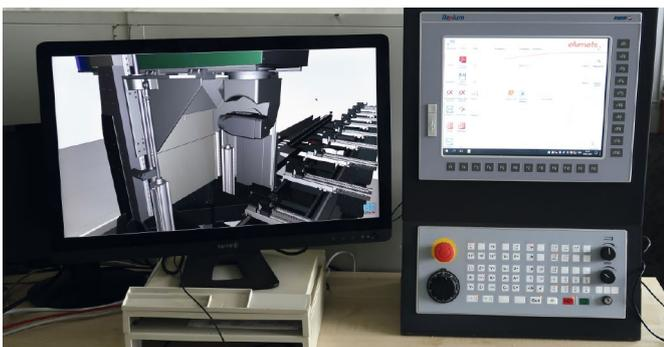
Dans le système de mise en service virtuelle chez elumatec, tous les composants de commande sont reproduits virtuellement un à un. Sur l'écran, on peut voir la tête d'usinage du SBZ 151
