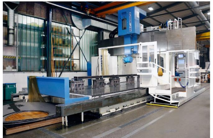
*Centre d'usinage à portique Modumill avec commande numérique NUM Flexium+*
